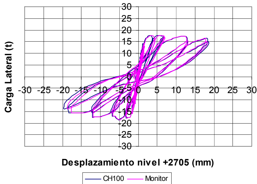
CISMID/FIC/UNI - Laboratorio de Estructuras Ensayo Ciclico en Muro-02 Original
