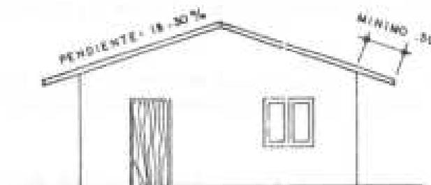
Los techos deberán ser livianos. El sistema tradicional de la estructura del techo consiste en viguetas de troncos de madera apoyadas sobre la viga solera. Para luces libres de techo comprendidas entre 3.00 y 3.50 mts. se recomiendan troncos de eucalipto de 4" de diámetro con un espaciamiento de 60 a 80 cm.
