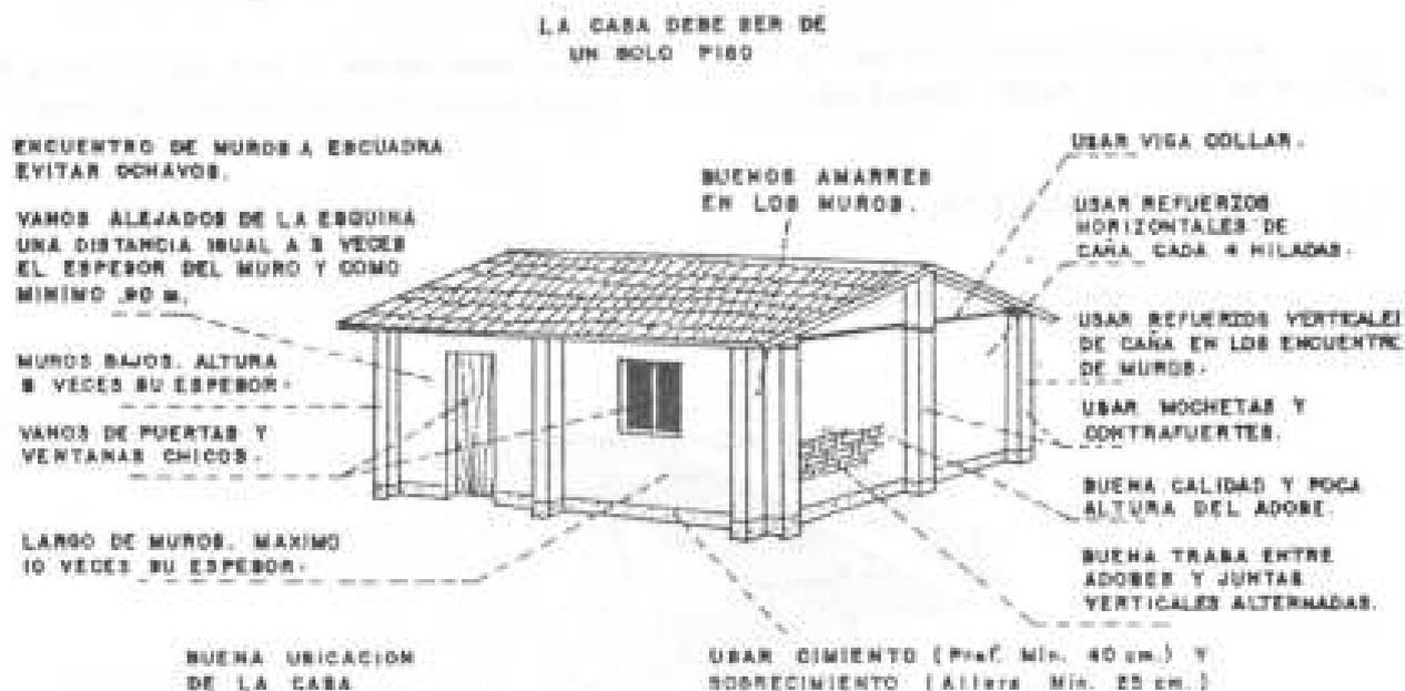
2. De preferencia se debe utilizar adobes cuadrados porque conducen a una solución simple de amarre de encuentros de muros; y permite la incorporación de mochetas, que es una solución para conseguir una mayor longitud de anclaje del refuerzo horizontal; y de contrafuertes, que es una solución para arriostramientos de muros largos.
