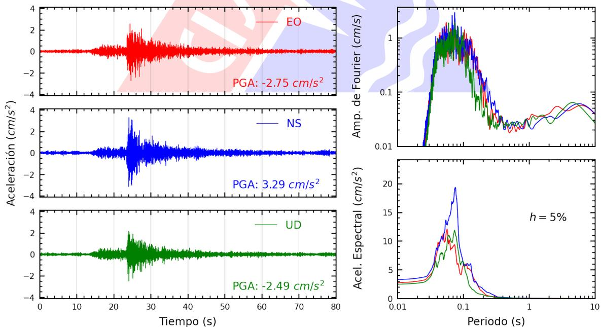
**Figura A.14:** Registros tiempo-historia, espectros de Fourier y de respuesta en las direcciones EO, NS y vertical de la estación SROSA. Sismo de Chilca, Cañete - Lima de 2022-08-26, 20:42:48 (Hora local)
