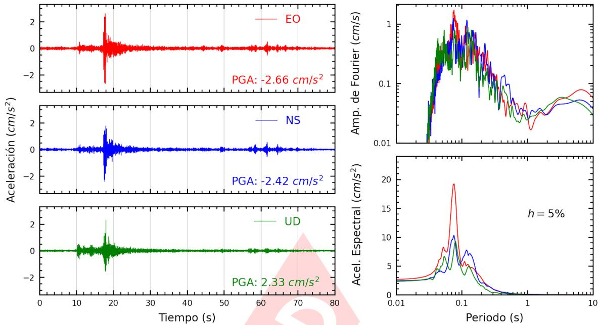
**Figura A.19:** Registros tiempo-historia, espectros de Fourier y de respuesta en las direcciones EO, NS y vertical de la estación UPCSM. Sismo de Chilca, Cañete - Lima de 2022-08-26, 20:42:48 (Hora local)
