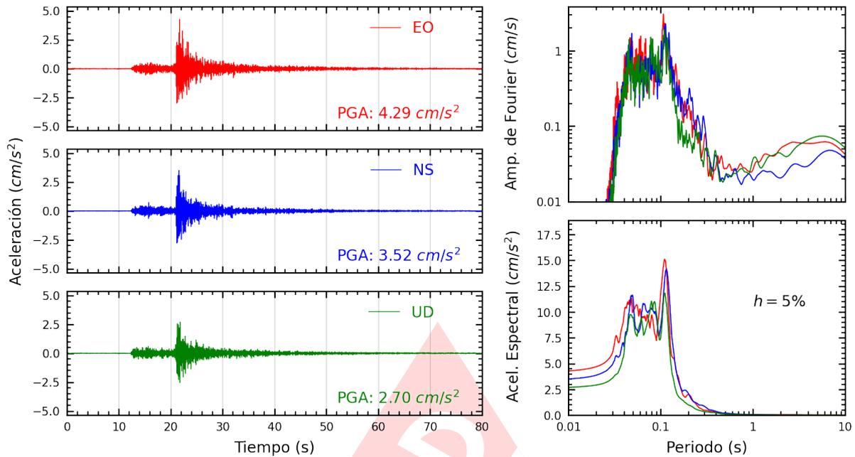
**Figura A.9:** Registros tiempo-historia, espectros de Fourier y de respuesta en las direcciones EO, NS y vertical de la estación AMORE. Sismo de Chilca, Cañete - Lima de 2022-08-26, 20:42:48 (Hora local)
