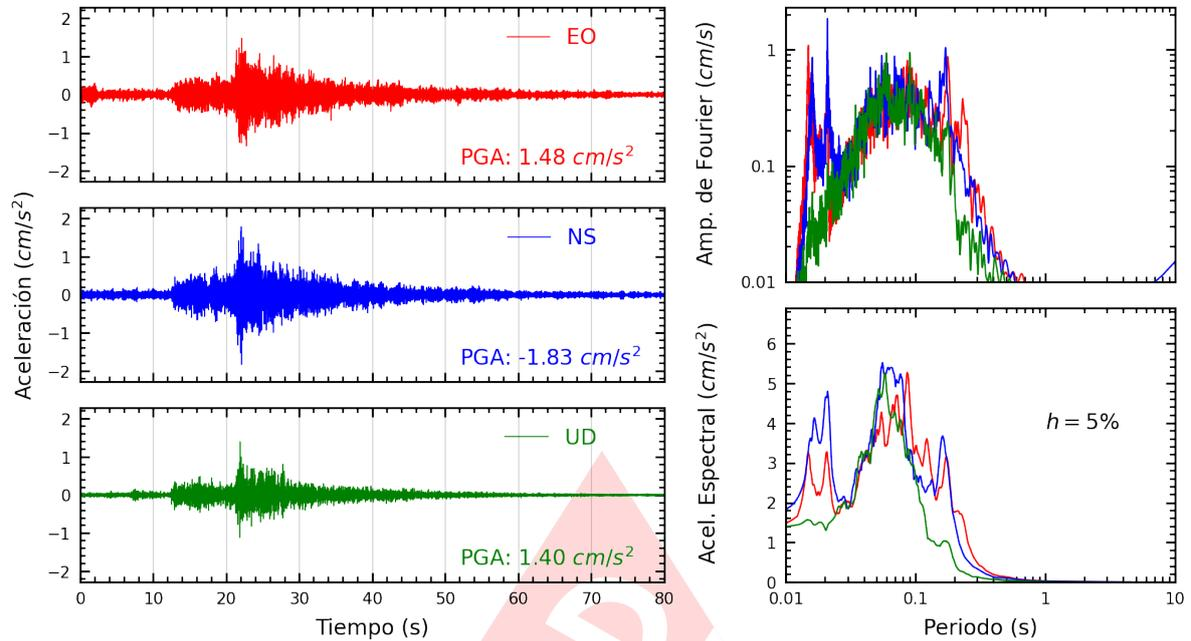
**Figura A.25:** Registros tiempo-historia, espectros de Fourier y de respuesta en las direcciones EO, NS y vertical de la estación ASIA. Sismo de Chilca, Cañete - Lima de 2022-08-26, 20:42:48 (Hora local)
