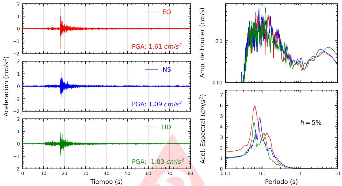
**Figura A.29:** Registros tiempo-historia, espectros de Fourier y de respuesta en las direcciones EO, NS y vertical de la estación BONDY. Sismo de Chilca, Cañete - Lima de 2022-08-26, 20:42:48 (Hora local)
