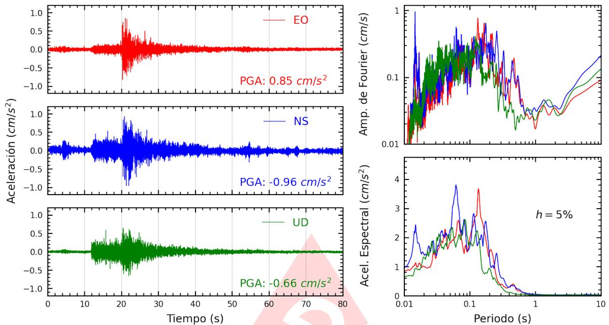
**Figura A.33:** Registros tiempo-historia, espectros de Fourier y de respuesta en las direcciones EO, NS y vertical de la estación VHAYA. Sismo de Chilca, Cañete - Lima de 2022-08-26, 20:42:48 (Hora local)
