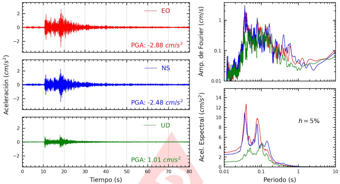
**Figura A.17:** Registros tiempo-historia, espectros de Fourier y de respuesta en las direcciones EO, NS y vertical de la estación DHNPE. Sismo de Chilca, Cañete - Lima de 2022-08-26, 20:42:48 (Hora local)
