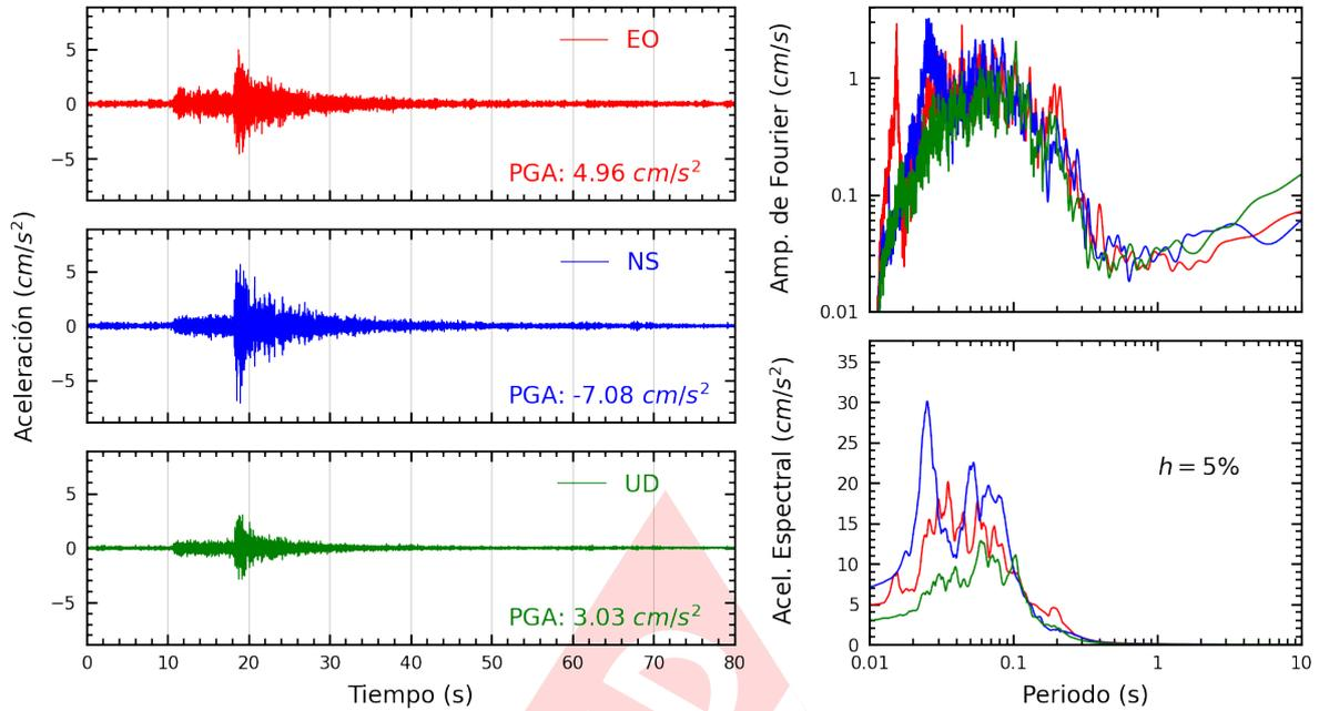
**Figura A.5:** Registros tiempo-historia, espectros de Fourier y de respuesta en las direcciones EO, NS y vertical de la estación INDEP. Sismo de Chilca, Cañete - Lima de 2022-08-26, 20:42:48 (Hora local)
