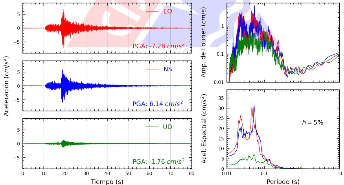
**Figura A.4:** Registros tiempo-historia, espectros de Fourier y de respuesta en las direcciones EO, NS y vertical de la estación JALVA. Sismo de Chilca, Cañete - Lima de 2022-08-26, 20:42:48 (Hora local)
