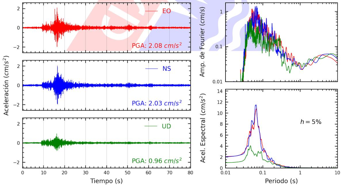
**Figura A.22:** Registros tiempo-historia, espectros de Fourier y de respuesta en las direcciones EO, NS y vertical de la estación UPCVI. Sismo de Chilca, Cañete - Lima de 2022-08-26, 20:42:48 (Hora local)
