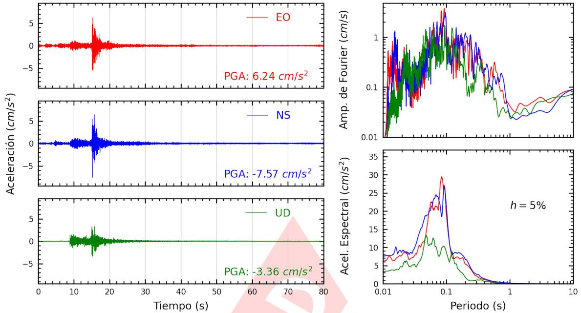
**Figura A.3:** Registros tiempo-historia, espectros de Fourier y de respuesta en las direcciones EO, NS y vertical de la estación USILP. Sismo de Chilca, Cañete - Lima de 2022-08-26, 20:42:48 (Hora local)
