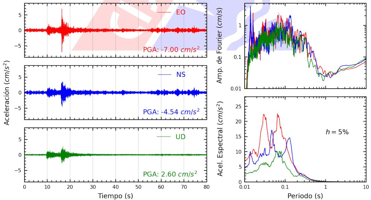
**Figura A.6:** Registros tiempo-historia, espectros de Fourier y de respuesta en las direcciones EO, NS y vertical de la estación URPE. Sismo de Chilca, Cañete - Lima de 2022-08-26, 20:42:48 (Hora local)
