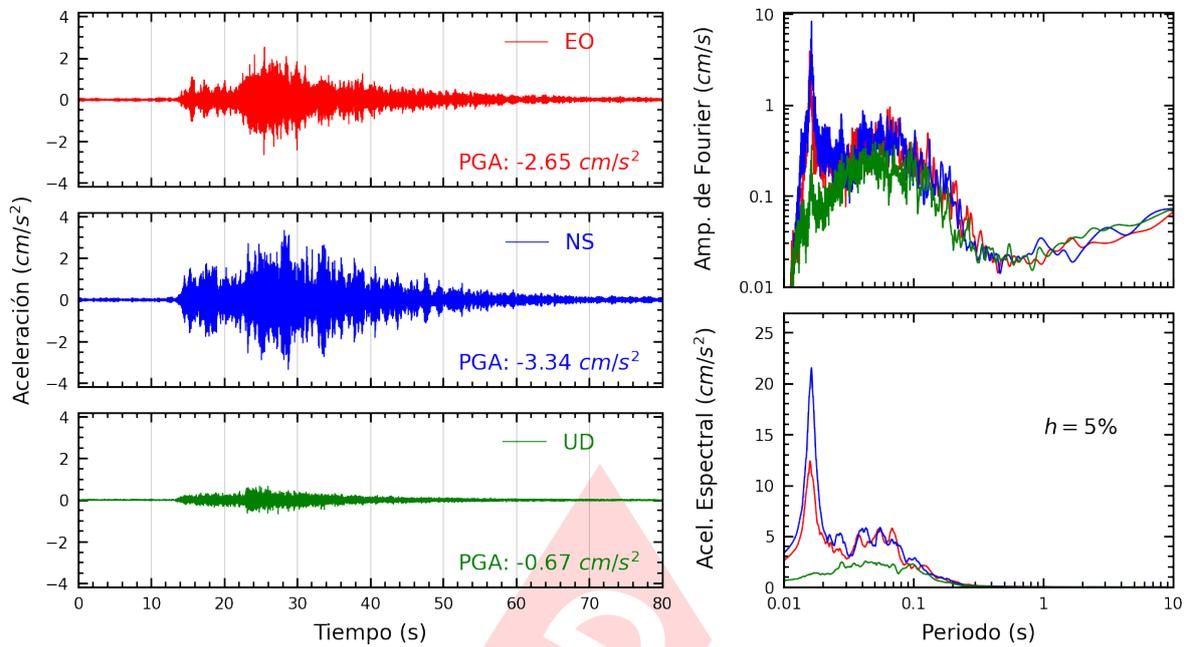
**Figura A.13:** Registros tiempo-historia, espectros de Fourier y de respuesta en las direcciones EO, NS y vertical de la estación IPEN. Sismo de Chilca, Cañete - Lima de 2022-08-26, 20:42:48 (Hora local)
