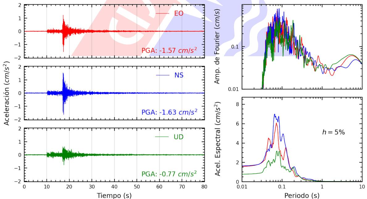
**Figura A.28:** Registros tiempo-historia, espectros de Fourier y de respuesta en las direcciones EO, NS y vertical de la estación UNFV. Sismo de Chilca, Cañete - Lima de 2022-08-26, 20:42:48 (Hora local)
