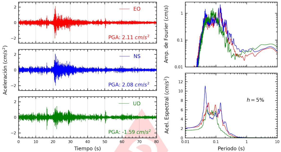
**Figura A.21:** Registros tiempo-historia, espectros de Fourier y de respuesta en las direcciones EO, NS y vertical de la estación CARAB. Sismo de Chilca, Cañete - Lima de 2022-08-26, 20:42:48 (Hora local)
