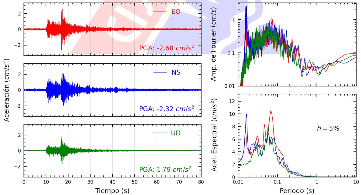
**Figura A.18:** Registros tiempo-historia, espectros de Fourier y de respuesta en las direcciones EO, NS y vertical de la estación CENEP. Sismo de Chilca, Cañete - Lima de 2022-08-26, 20:42:48 (Hora local)
