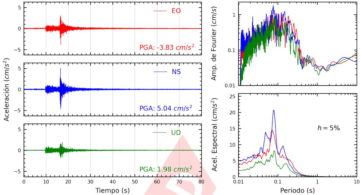
**Figura A.7:** Registros tiempo-historia, espectros de Fourier y de respuesta en las direcciones EO, NS y vertical de la estación SERVI. Sismo de Chilca, Cañete - Lima de 2022-08-26, 20:42:48 (Hora local)
