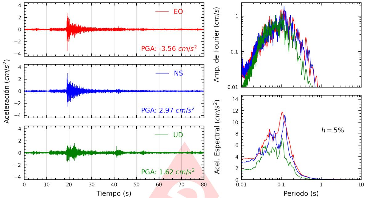
**Figura A.11:** Registros tiempo-historia, espectros de Fourier y de respuesta en las direcciones EO, NS y vertical de la estación SCOLI. Sismo de Chilca, Cañete - Lima de 2022-08-26, 20:42:48 (Hora local)
