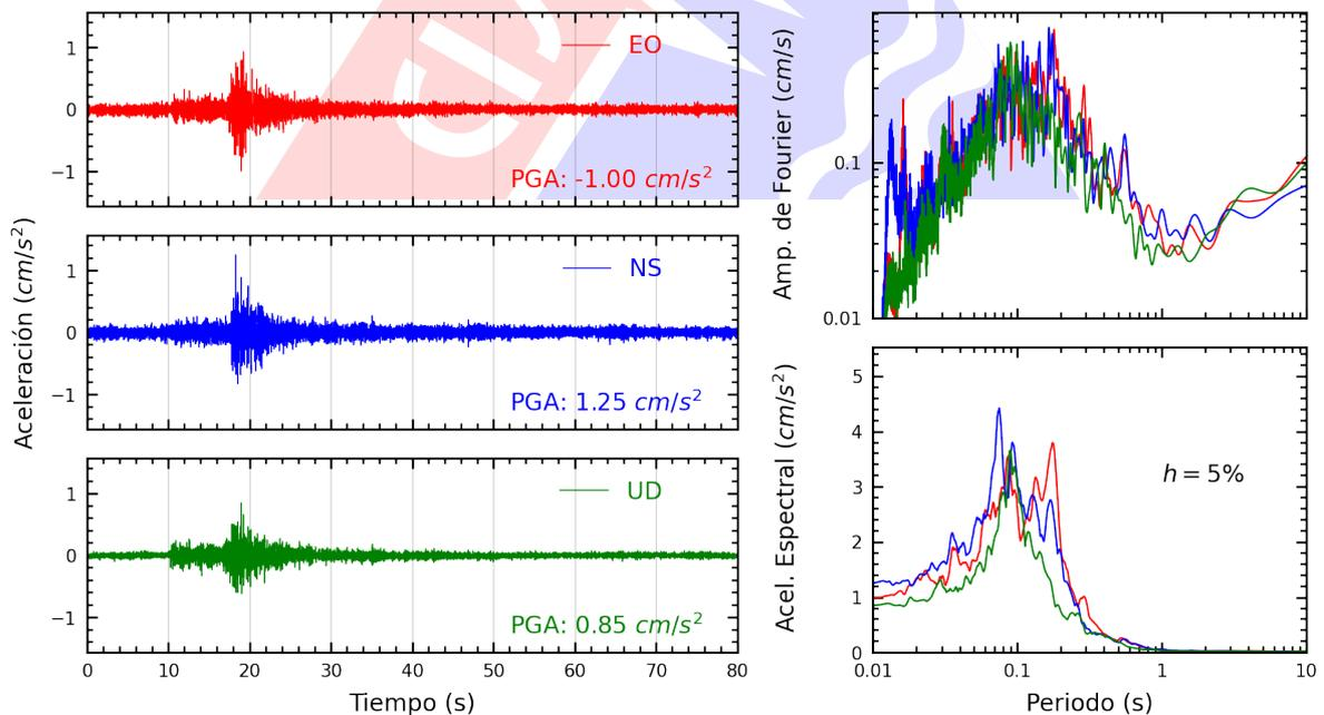
**Figura A.32:** Registros tiempo-historia, espectros de Fourier y de respuesta en las direcciones EO, NS y vertical de la estación NISTA. Sismo de Chilca, Cañete - Lima de 2022-08-26, 20:42:48 (Hora local)
