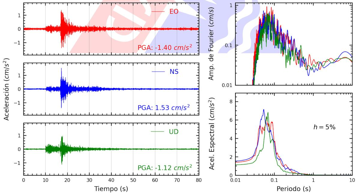
**Figura A.30:** Registros tiempo-historia, espectros de Fourier y de respuesta en las direcciones EO, NS y vertical de la estación INICT. Sismo de Chilca, Cañete - Lima de 2022-08-26, 20:42:48 (Hora local)
