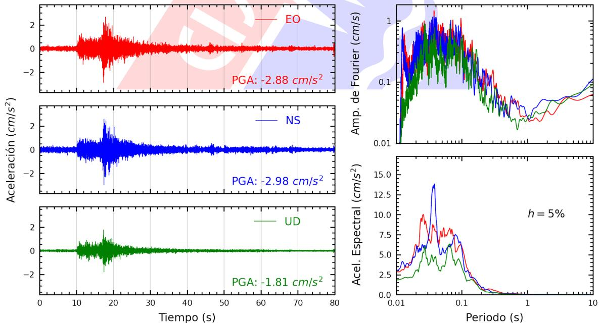
**Figura A.16:** Registros tiempo-historia, espectros de Fourier y de respuesta en las direcciones EO, NS y vertical de la estación CEPRE. Sismo de Chilca, Cañete - Lima de 2022-08-26, 20:42:48 (Hora local)
