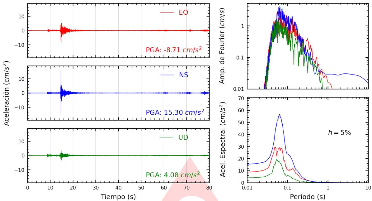
**Figura A.1:** Registros tiempo-historia, espectros de Fourier y de respuesta en las direcciones EO, NS y vertical de la estación PACHA. Sismo de Chilca, Cañete - Lima de 2022-08-26, 20:42:48 (Hora local)
