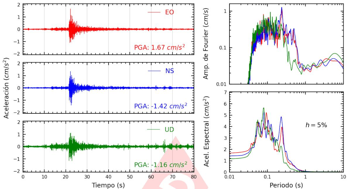
**Figura A.27:** Registros tiempo-historia, espectros de Fourier y de respuesta en las direcciones EO, NS y vertical de la estación MDPP. Sismo de Chilca, Cañete - Lima de 2022-08-26, 20:42:48 (Hora local)
