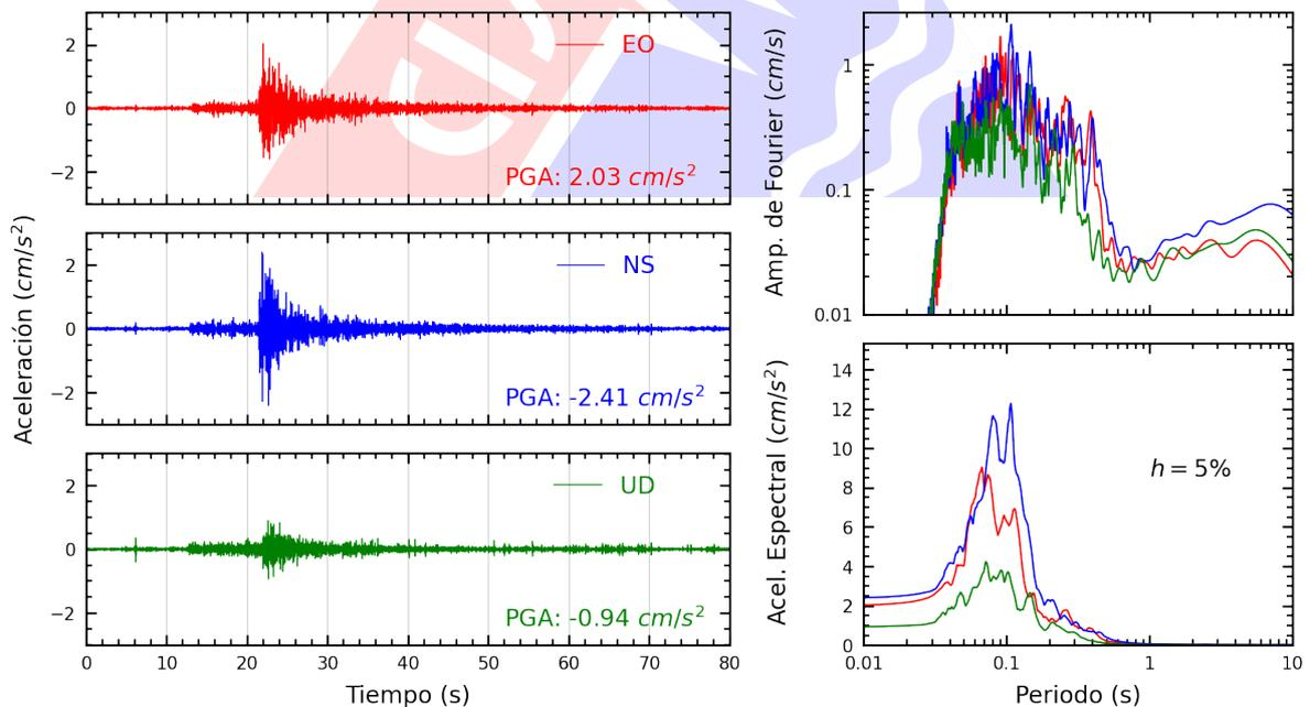
**Figura A.20:** Registros tiempo-historia, espectros de Fourier y de respuesta en las direcciones EO, NS y vertical de la estación DEFEN. Sismo de Chilca, Cañete - Lima de 2022-08-26, 20:42:48 (Hora local)
