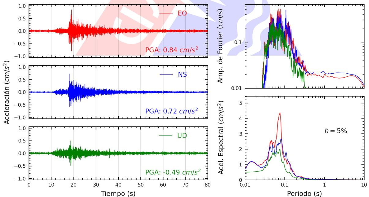
**Figura A.34:** Registros tiempo-historia, espectros de Fourier y de respuesta en las direcciones EO, NS y vertical de la estación ATARJ. Sismo de Chilca, Cañete - Lima de 2022-08-26, 20:42:48 (Hora local)
