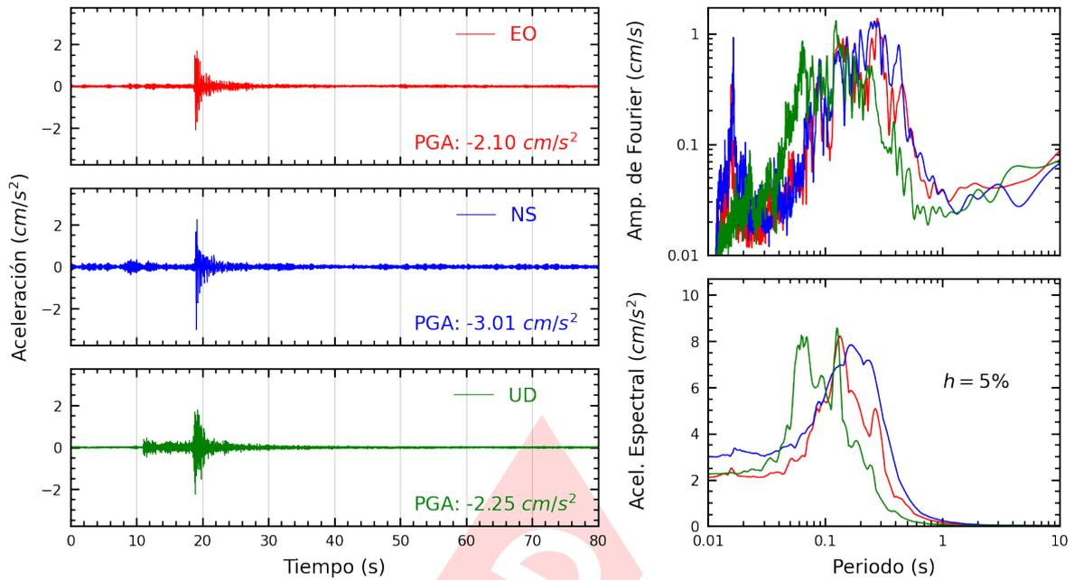
**Figura A.15:** Registros tiempo-historia, espectros de Fourier y de respuesta en las direcciones EO, NS y vertical de la estación ACAPU. Sismo de Chilca, Cañete - Lima de 2022-08-26, 20:42:48 (Hora local)
