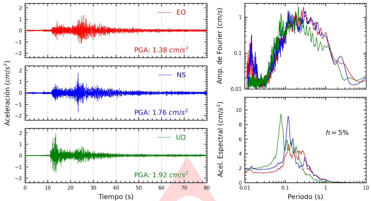
**Figura A.1:** Registros tiempo-historia, espectros de Fourier y de respuesta en las direcciones EO, NS y vertical de la estación UNICA. Sismo de Pisco, Pisco - Ica del 2022-09-12, 22:22:51 (Hora local)
