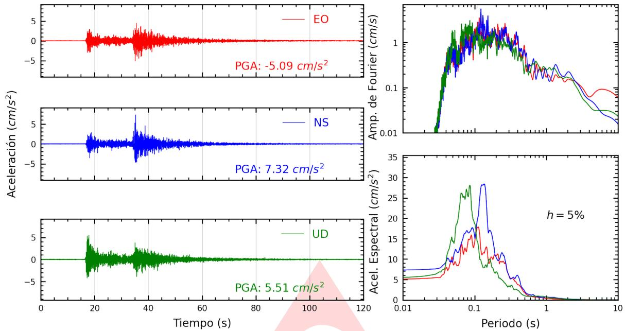
**Figura A.1:** Registros tiempo-historia, espectros de Fourier y de respuesta en las direcciones EO, NS y vertical de la estación UJBG3. Sismo de Calana, Tacna - Tacna del 2022-10-17, 08:38:23 (Hora local)
