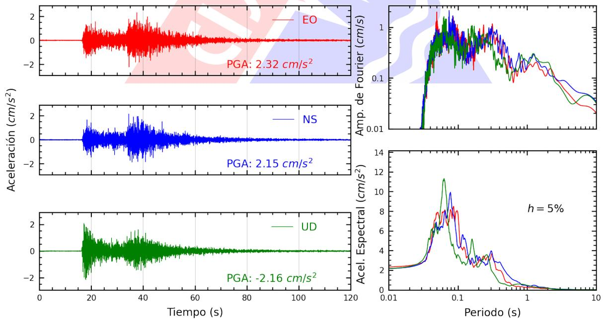
**Figura A.4:** Registros tiempo-historia, espectros de Fourier y de respuesta en las direcciones EO, NS y vertical de la estación CREY. Sismo de Calana, Tacna - Tacna del 2022-10-17, 08:38:23 (Hora local)
