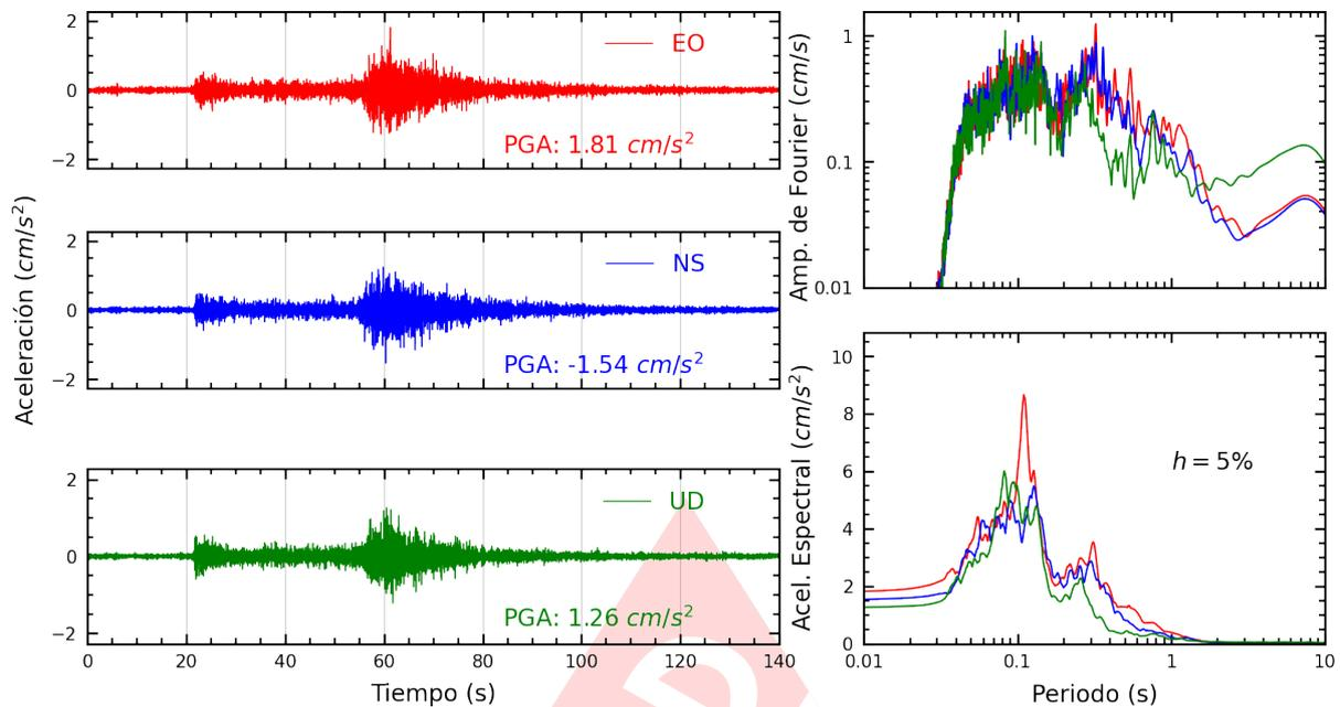
**Figura A.5:** Registros tiempo-historia, espectros de Fourier y de respuesta en las direcciones EO, NS y vertical de la estación SCARQ. Sismo de Calana, Tacna - Tacna del 2022-10-17, 08:38:23 (Hora local)
