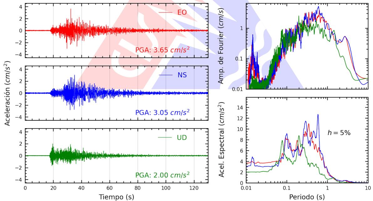
**Figura A.2:** Registros tiempo-historia, espectros de Fourier y de respuesta en las direcciones EO, NS y vertical de la estación UNICA. Sismo de Ica, Ica - Ica del 2022-10-28, 04:11:51 (Hora local)
