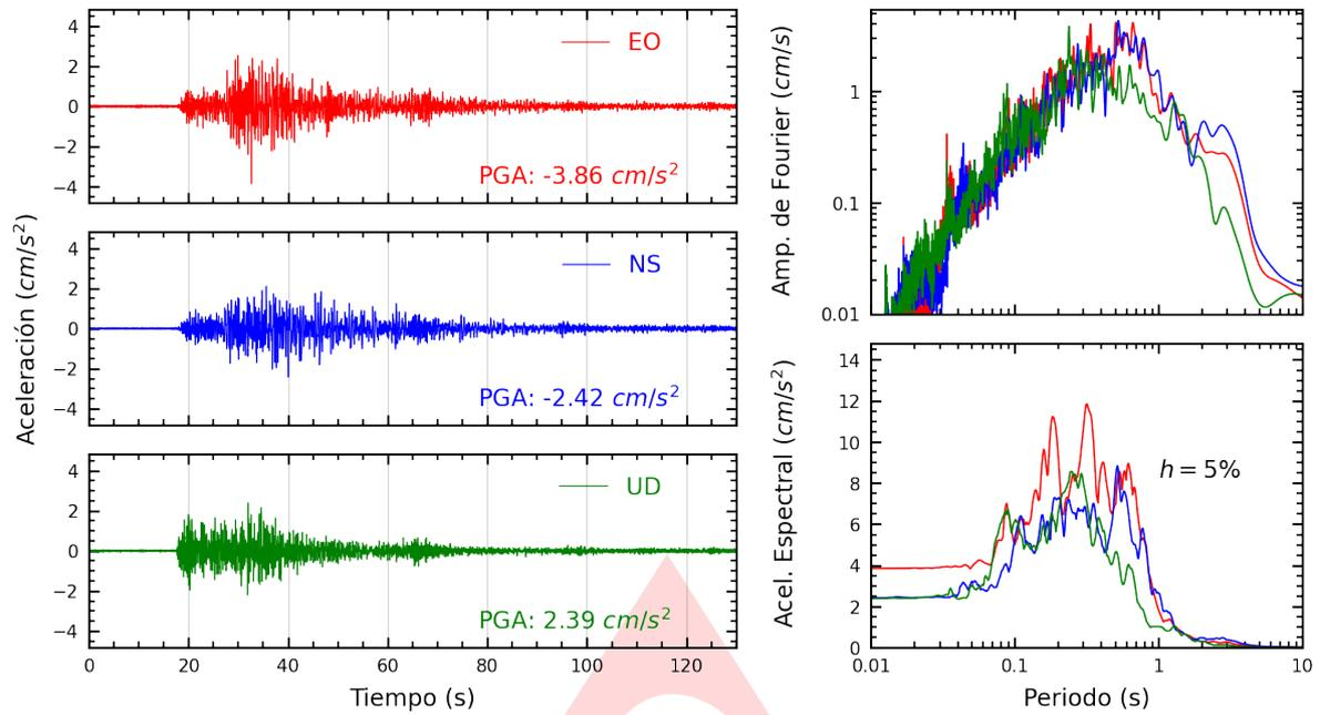
**Figura A.1:** Registros tiempo-historia, espectros de Fourier y de respuesta en las direcciones EO, NS y vertical de la estación SCICA. Sismo de Ica, Ica - Ica del 2022-10-28, 04:11:51 (Hora local)
