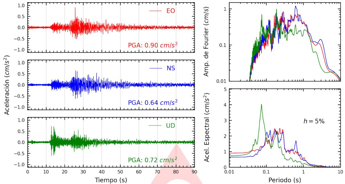
**Figura A.1:** Registros tiempo-historia, espectros de Fourier y de respuesta en las direcciones EO, NS y vertical de la estación UNICA. Sismo de Ica, Ica - Ica del 2022-10-29, 09:37:15 (Hora local)
