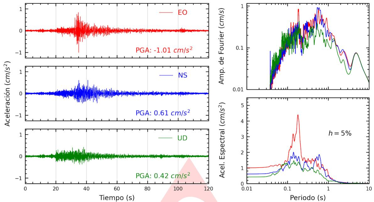
**Figura A.1:** Registros tiempo-historia, espectros de Fourier y de respuesta en las direcciones EO, NS y vertical de la estación UNICA. Sismo de Ica, Ica - Ica del 2022-10-29, 16:18:22 (Hora local)
