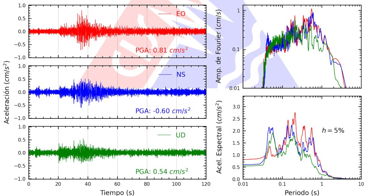
**Figura A.2:** Registros tiempo-historia, espectros de Fourier y de respuesta en las direcciones EO, NS y vertical de la estación SCICA. Sismo de Ica, Ica - Ica del 2022-10-29, 16:18:22 (Hora local)
