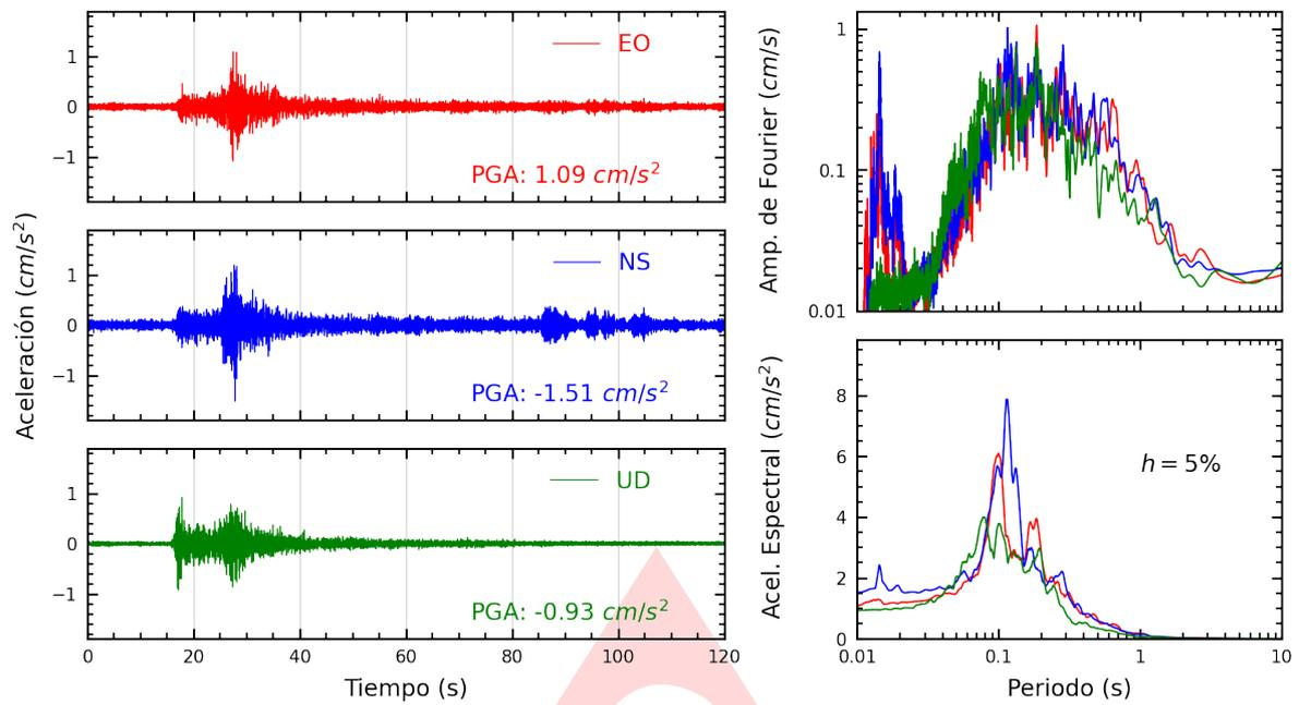
**Figura A.1:** Registros tiempo-historia, espectros de Fourier y de respuesta en las direcciones EO, NS y vertical de la estación UNICA. Sismo de Ica, Ica - Ica del 2022-10-29, 18:47:22 (Hora local)
