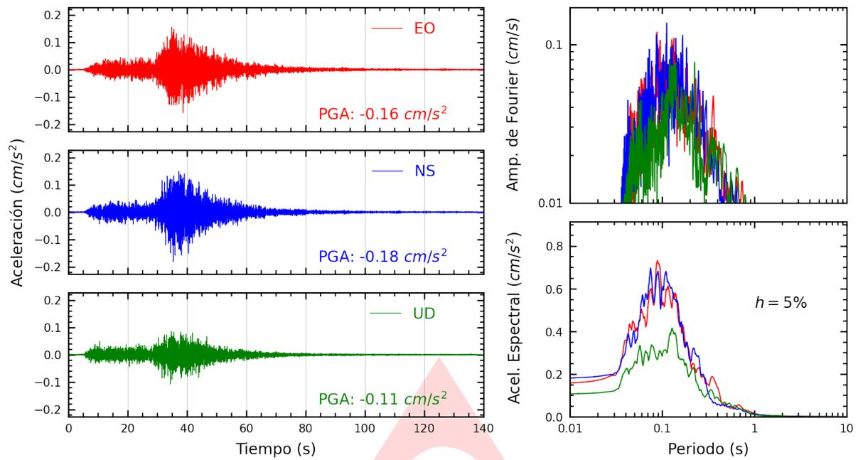
**Figura A.1:** Registros tiempo-historia, espectros de Fourier y de respuesta en las direcciones EO, NS y vertical de la estación UNSA. Sismo de Atico, Caraveli - Arequipa del 2022-10-30, 22:50:02 (Hora local)
