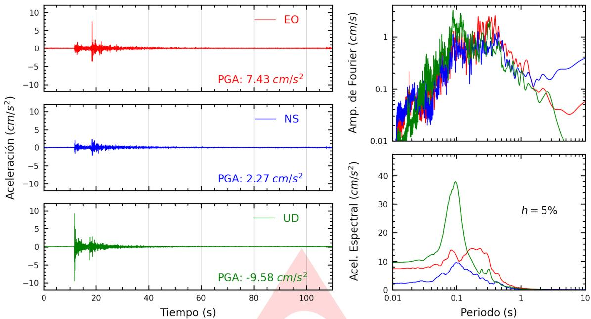
**Figura A.1:** Registros tiempo-historia, espectros de Fourier y de respuesta en las direcciones EO, NS y vertical de la estación SCPIU. Sismo de Paita, Paita - Piura del 2022-11-02, 20:14:21 (Hora local)
