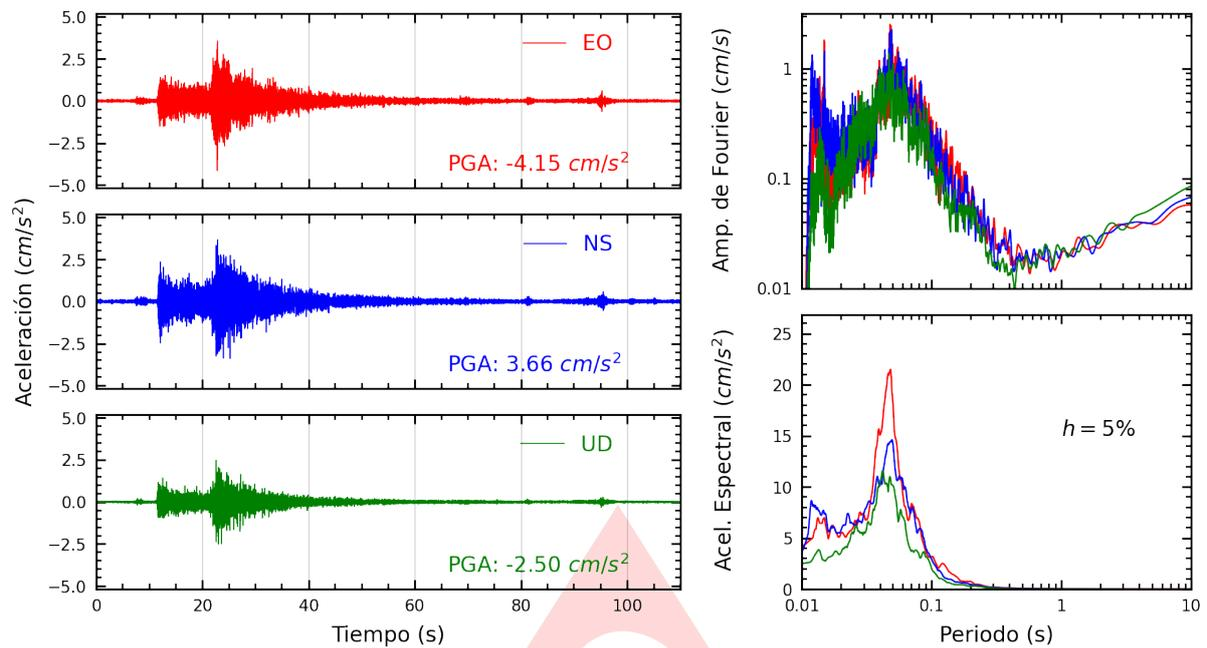
**Figura A.1:** Registros tiempo-historia, espectros de Fourier y de respuesta en las direcciones EO, NS y vertical de la estación USP. Sismo de Chimbote, Santa - Ancash del 2022-11-21, 03:48:27 (Hora local)
