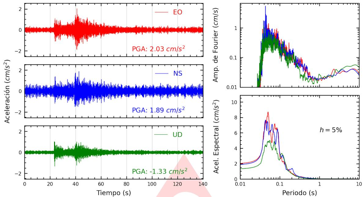
**Figura A.1:** Registros tiempo-historia, espectros de Fourier y de respuesta en las direcciones EO, NS y vertical de la estación USP. Sismo de Salaverry, Trujillo - La Libertad del 2022-11-29, 17:15:49 (Hora local)
