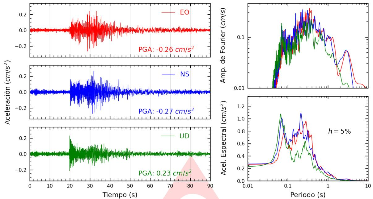
**Figura A.1:** Registros tiempo-historia, espectros de Fourier y de respuesta en las direcciones EO, NS y vertical de la estación UNAJ. Sismo de Santa Lucia, Lampa - Puno del 2021-10-03, 05:02:48 (Hora local)
