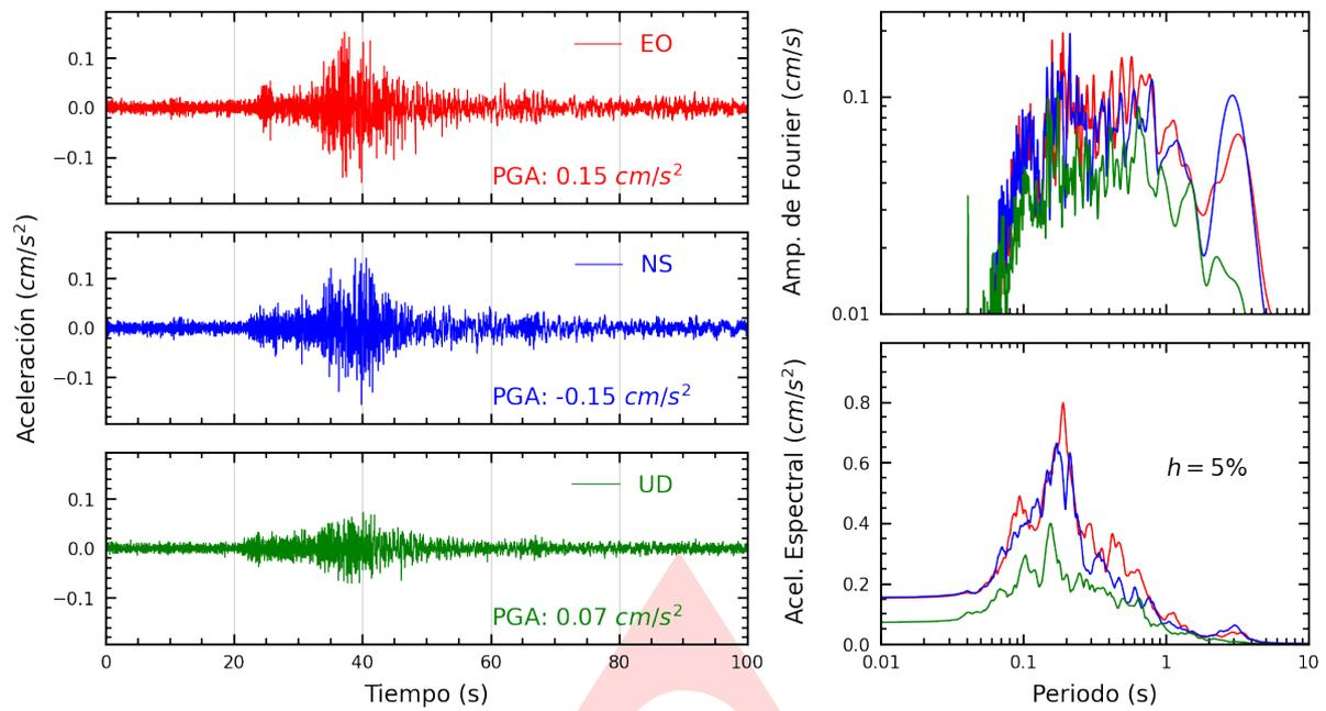
**Figura A.1:** Registros tiempo-historia, espectros de Fourier y de respuesta en las direcciones EO, NS y vertical de la estación UNAJ. Sismo de Ocuvi, Lampa - Puno del 2022-02-10, 02:38:56 (Hora local)
