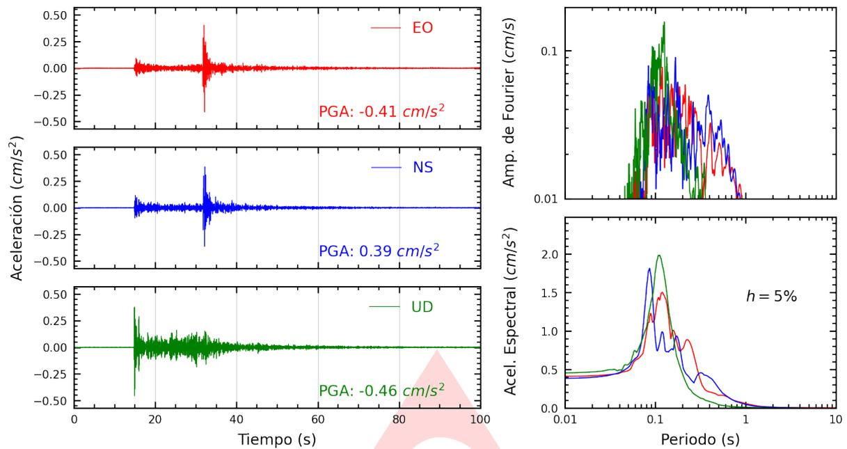
**Figura A.1:** Registros tiempo-historia, espectros de Fourier y de respuesta en las direcciones EO, NS y vertical de la estación UNIA. Sismo de Pucallpa, Coronel Portillo - Ucayali del 2023-01-13, 02:38:37 (Hora local)
