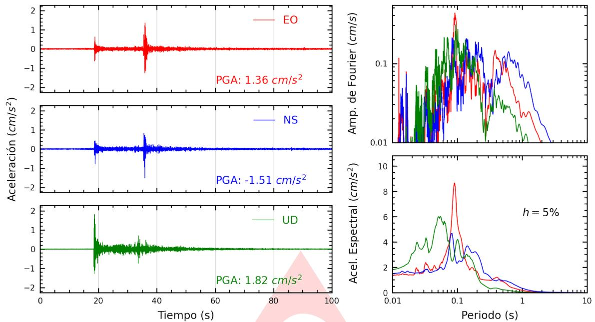
**Figura A.1:** Registros tiempo-historia, espectros de Fourier y de respuesta en las direcciones EO, NS y vertical de la estación UNIA. Sismo de Pucallpa, Coronel Portillo - Ucayali del 2023-01-15, 06:27:13 (Hora local)
