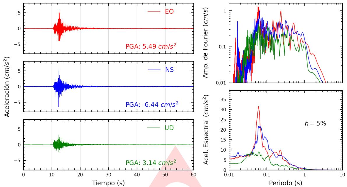
**Figura A.1:** Registros tiempo-historia, espectros de Fourier y de respuesta en las direcciones EO, NS y vertical de la estación UNMBA. Sismo de Abancay, Abancay - Apurímac del 2023-01-23, 21:38:47 (Hora local)
