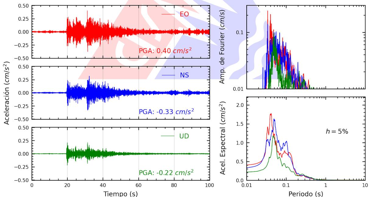
**Figura A.2:** Registros tiempo-historia, espectros de Fourier y de respuesta en las direcciones EO, NS y vertical de la estación UNAM. Sismo de Omate, General Sanchez Cerro - Moquegua del 2023-02-02, 09:37:23 (Hora local)
