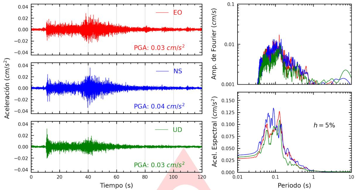
**Figura A.1:** Registros tiempo-historia, espectros de Fourier y de respuesta en las direcciones EO, NS y vertical de la estación UNSA. Sismo de Chachas, Castilla - Arequipa del 2023-03-05, 00:18:26 (Hora local)
