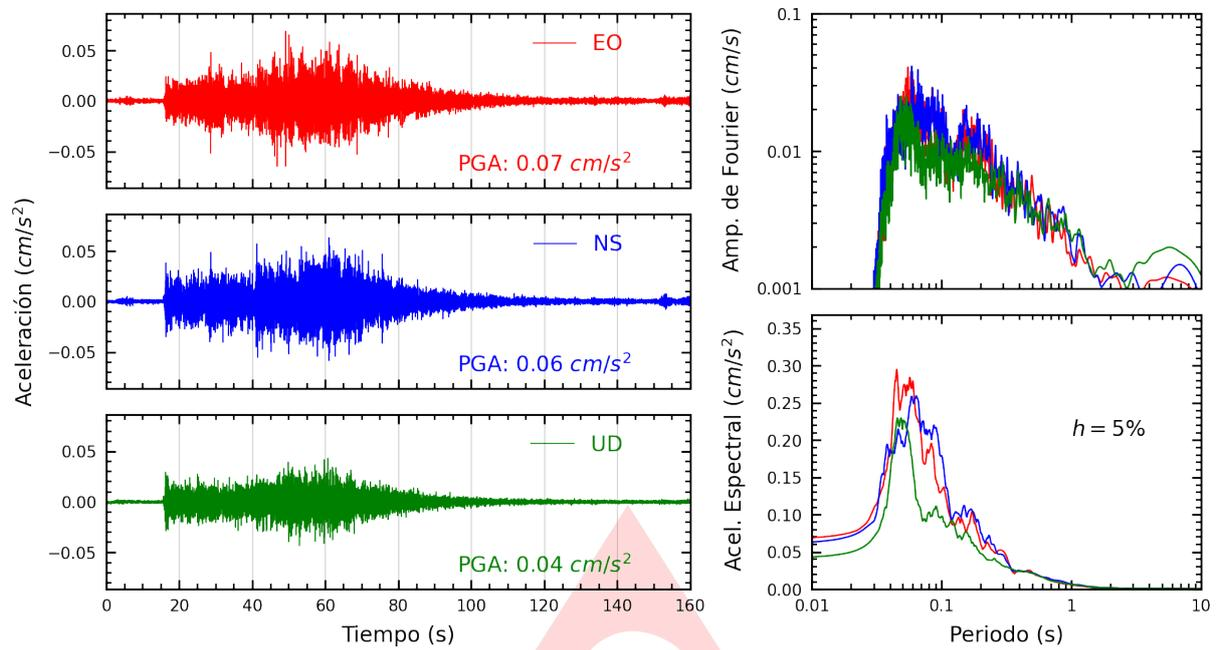
**Figura A.1:** Registros tiempo-historia, espectros de Fourier y de respuesta en las direcciones EO, NS y vertical de la estación UNSA. Sismo de Atico, Caraveli - Arequipa del 2023-03-25, 11:27:13 (Hora local)
