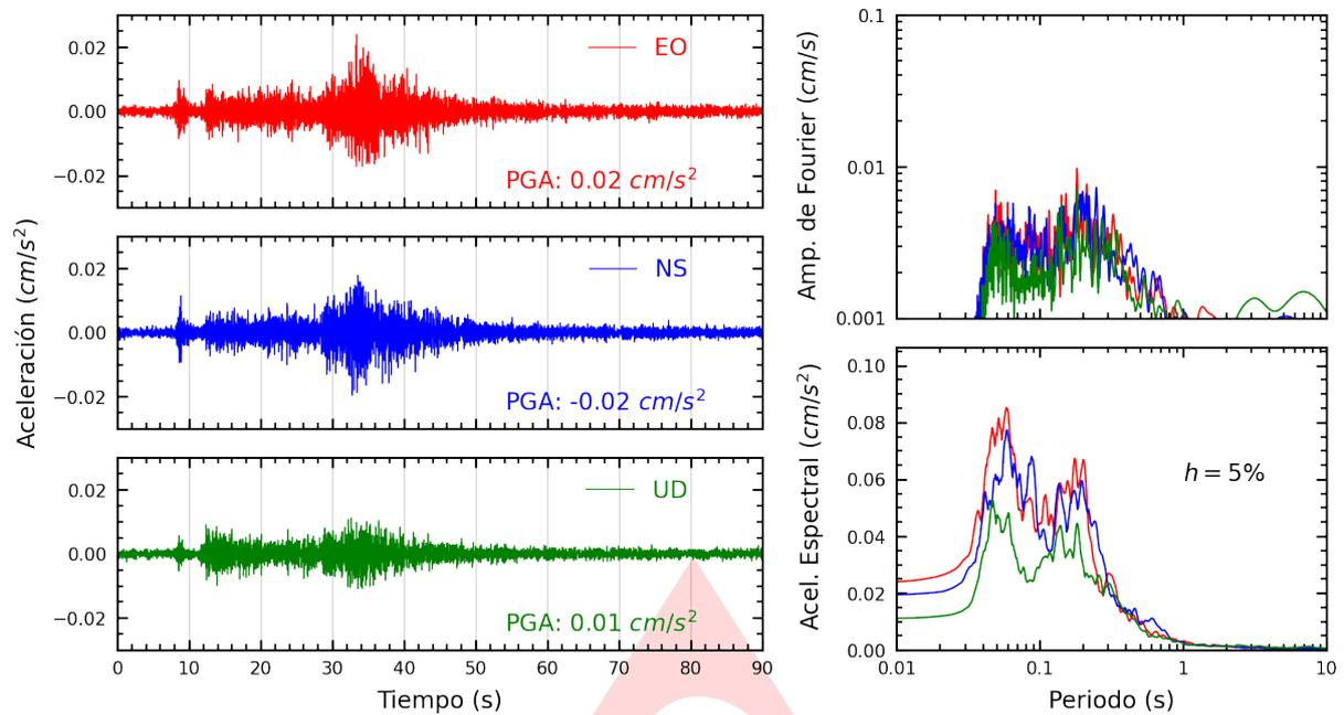
**Figura A.1:** Registros tiempo-historia, espectros de Fourier y de respuesta en las direcciones EO, NS y vertical de la estación UNSA. Sismo de Maca, Caylloma - Arequipa del 2023-06-01, 19:14:43 (Hora local)
