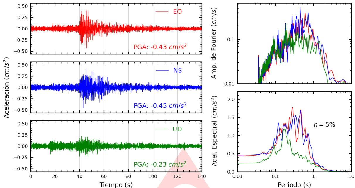
**Figura A.1:** Registros tiempo-historia, espectros de Fourier y de respuesta en las direcciones EO, NS y vertical de la estación UNICA. Sismo de Lomas, Caraveli - Arequipa del 2023-06-02, 09:06:39 (Hora local)
