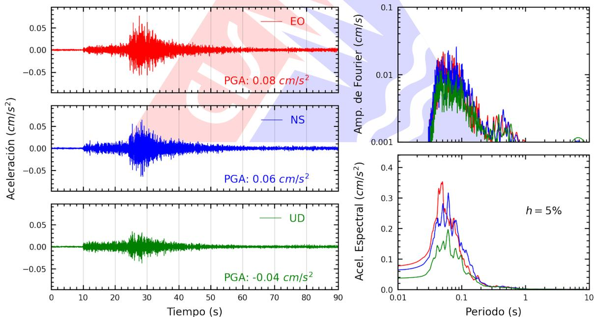
**Figura A.2:** Registros tiempo-historia, espectros de Fourier y de respuesta en las direcciones EO, NS y vertical de la estación UNSA. Sismo de Lomas, Caraveli - Arequipa del 2023-06-02, 09:06:39 (Hora local)
