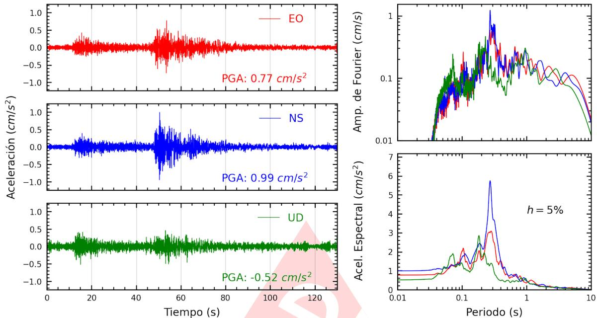
**Figura A.5:** Registros tiempo-historia, espectros de Fourier y de respuesta en las direcciones EO, NS y vertical de la estación SCTAC. Sismo de Maca, Caylloma - Arequipa del 2023-06-02, 20:49:13 (Hora local)
