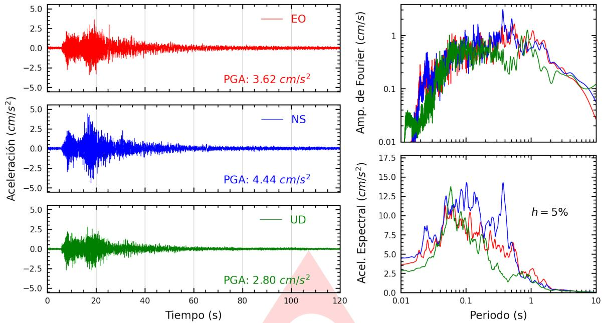
**Figura A.1:** Registros tiempo-historia, espectros de Fourier y de respuesta en las direcciones EO, NS y vertical de la estación SCARQ. Sismo de Maca, Caylloma - Arequipa del 2023-06-02, 20:49:13 (Hora local)
