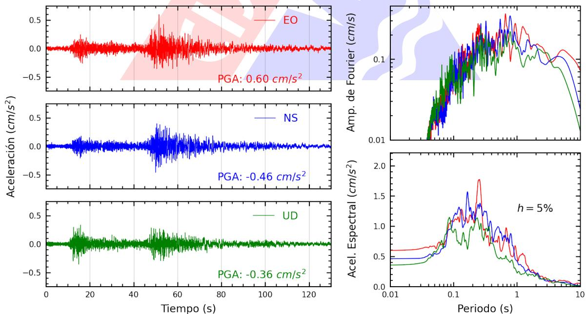
**Figura A.6:** Registros tiempo-historia, espectros de Fourier y de respuesta en las direcciones EO, NS y vertical de la estación UJBG3. Sismo de Maca, Caylloma - Arequipa del 2023-06-02, 20:49:13 (Hora local)
