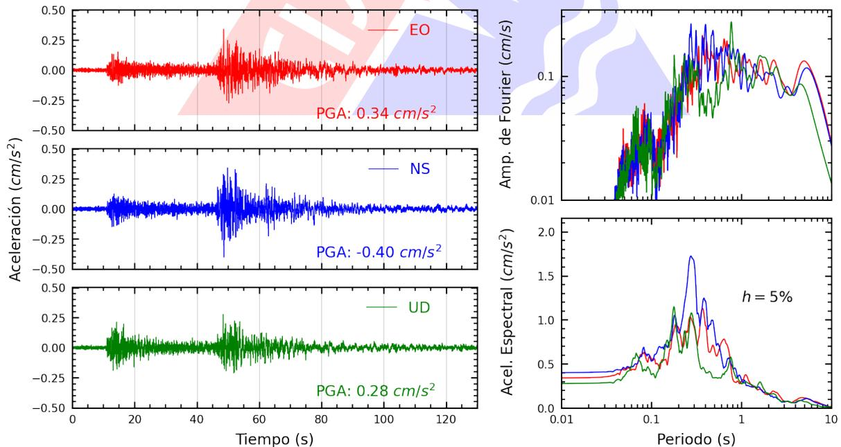
**Figura A.8:** Registros tiempo-historia, espectros de Fourier y de respuesta en las direcciones EO, NS y vertical de la estación CREY. Sismo de Maca, Caylloma - Arequipa del 2023-06-02, 20:49:13 (Hora local)
