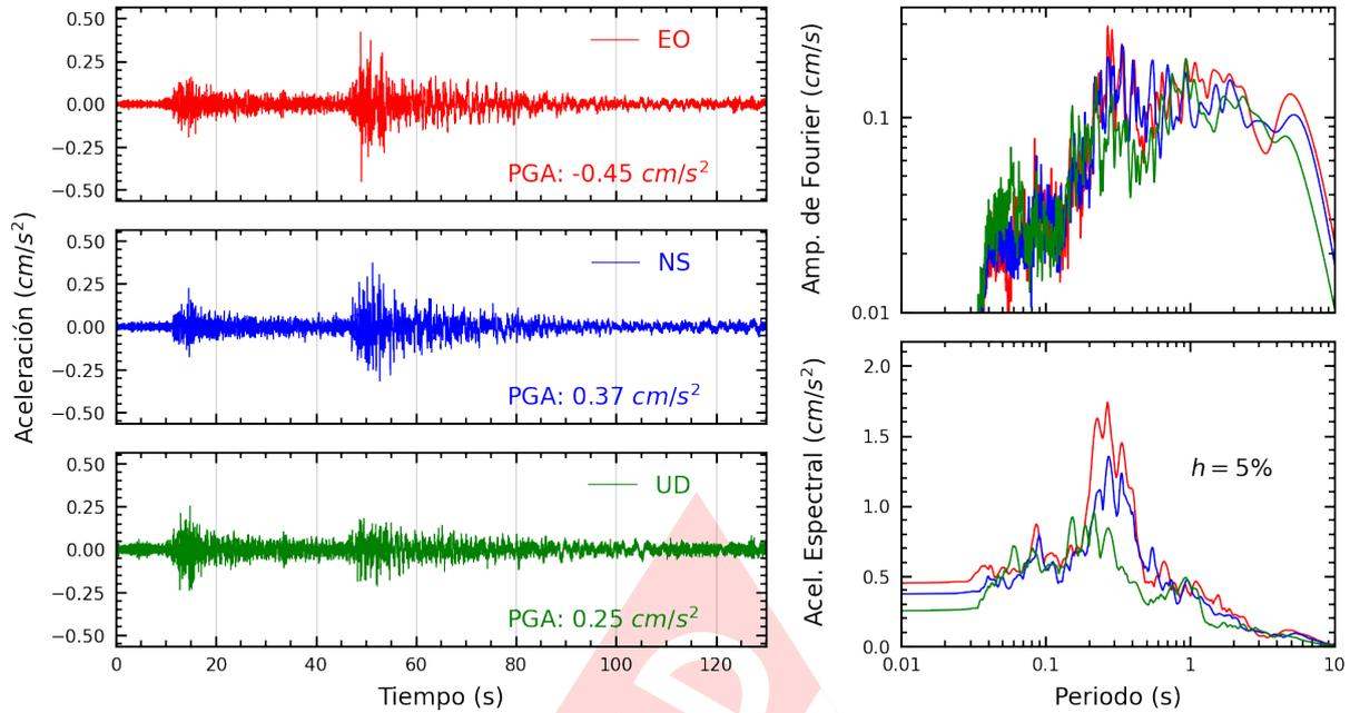
**Figura A.7:** Registros tiempo-historia, espectros de Fourier y de respuesta en las direcciones EO, NS y vertical de la estación UJBG2. Sismo de Maca, Caylloma - Arequipa del 2023-06-02, 20:49:13 (Hora local)
