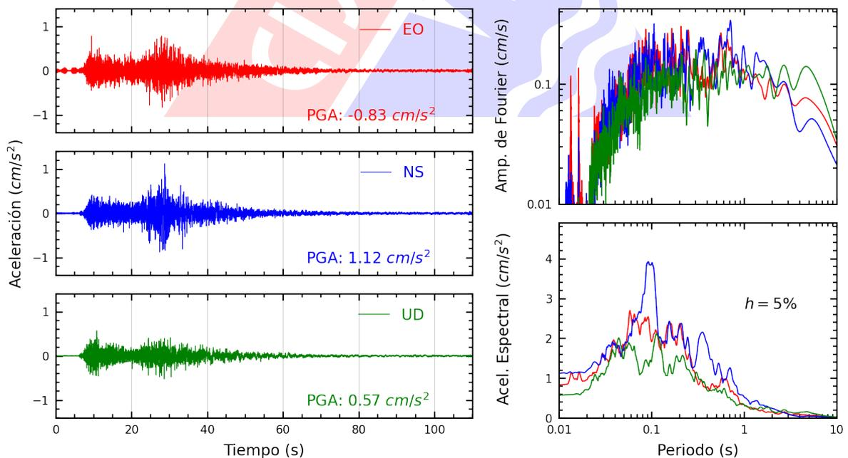
**Figura A.4:** Registros tiempo-historia, espectros de Fourier y de respuesta en las direcciones EO, NS y vertical de la estación UNSA. Sismo de Maca, Caylloma - Arequipa del 2023-06-02, 20:49:13 (Hora local)
