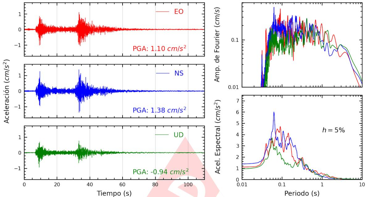
**Figura A.3:** Registros tiempo-historia, espectros de Fourier y de respuesta en las direcciones EO, NS y vertical de la estación UNAM. Sismo de Maca, Caylloma - Arequipa del 2023-06-02, 20:49:13 (Hora local)
