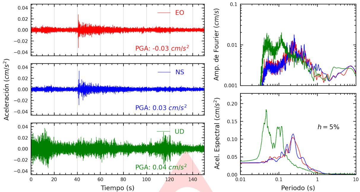
**Figura A.1:** Registros tiempo-historia, espectros de Fourier y de respuesta en las direcciones EO, NS y vertical de la estación SCPUC. Sismo de Atalaya, Atalaya - Ucayali del 2023-07-10, 00:46:18 (Hora local)
