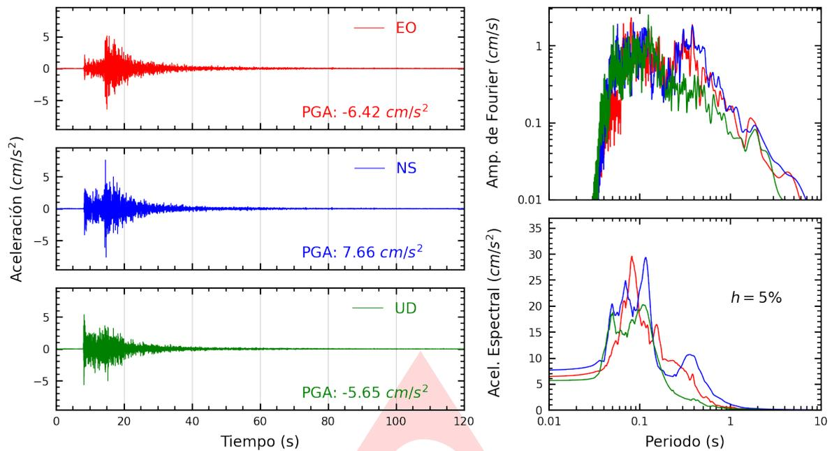
**Figura A.1:** Registros tiempo-historia, espectros de Fourier y de respuesta en las direcciones EO, NS y vertical de la estación UPAOP. Sismo de Sullana, Sullana - Piura del 2023-07-10, 18:46:32 (Hora local)
