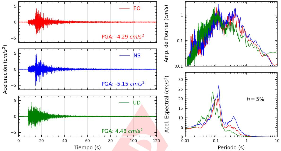
**Figura A.3:** Registros tiempo-historia, espectros de Fourier y de respuesta en las direcciones EO, NS y vertical de la estación SCPIU. Sismo de Sullana, Sullana - Piura del 2023-07-10, 18:46:32 (Hora local)
