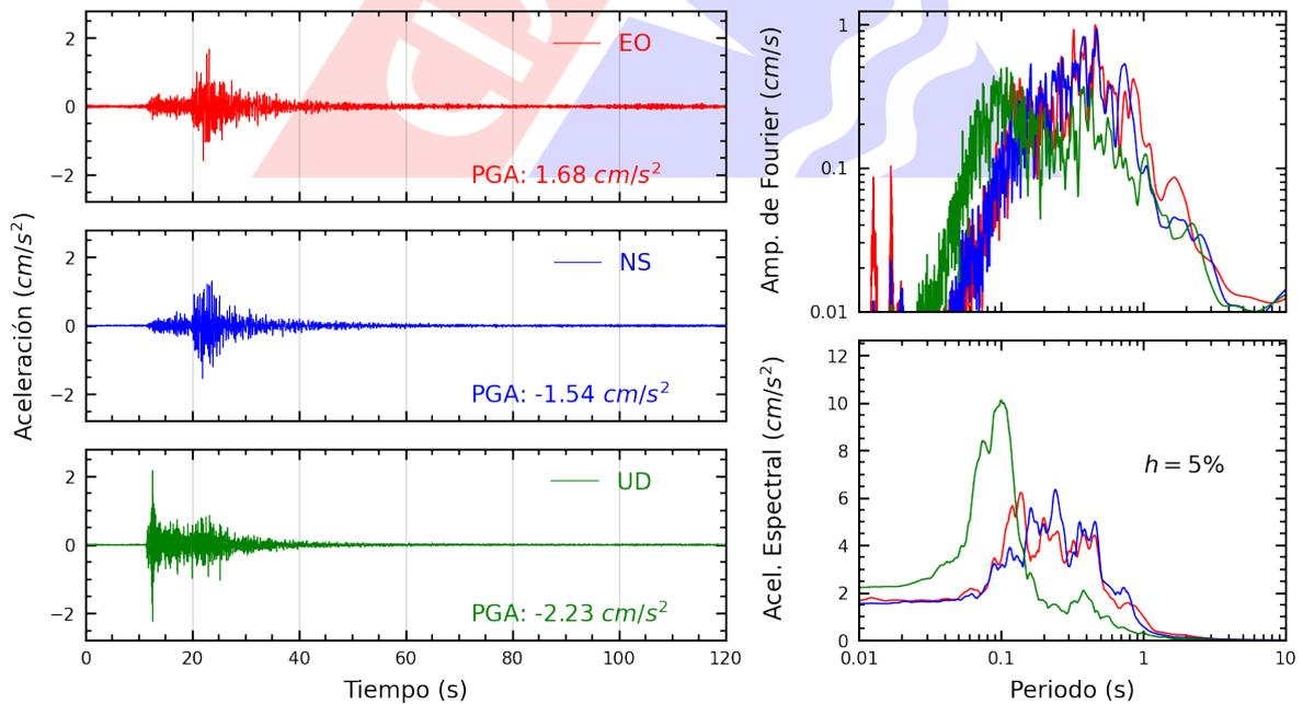
**Figura A.4:** Registros tiempo-historia, espectros de Fourier y de respuesta en las direcciones EO, NS y vertical de la estación UNIPE. Sismo de Sullana, Sullana - Piura del 2023-07-10, 18:46:32 (Hora local)
