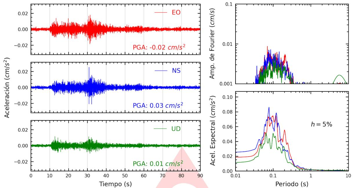
**Figura A.1:** Registros tiempo-historia, espectros de Fourier y de respuesta en las direcciones EO, NS y vertical de la estación UNSA. Sismo de Cabanaconde, Caylloma - Arequipa del 2023-07-24, 13:11:10 (Hora local)
