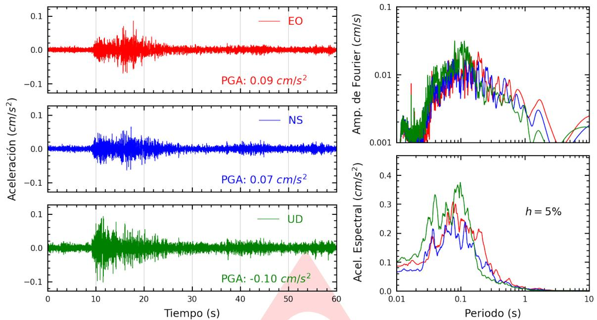
**Figura A.1:** Registros tiempo-historia, espectros de Fourier y de respuesta en las direcciones EO, NS y vertical de la estación SCCUS. Sismo de Andahuaylillas, Quispicanchi - Cusco del 2023-08-21, 01:10:37 (Hora local)
