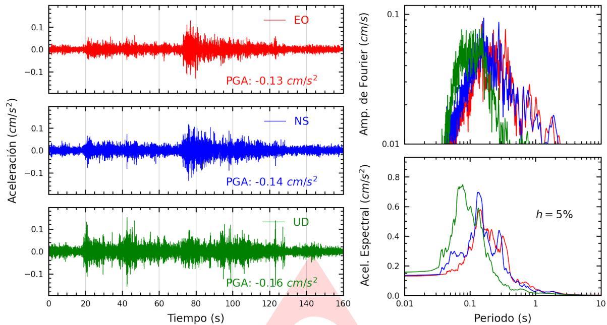
**Figura A.1:** Registros tiempo-historia, espectros de Fourier y de respuesta en las direcciones EO, NS y vertical de la estación UNP. Sismo de Pastaza, Alto Amazonas - Loreto del 2023-08-31, 04:38:06 (Hora local)
