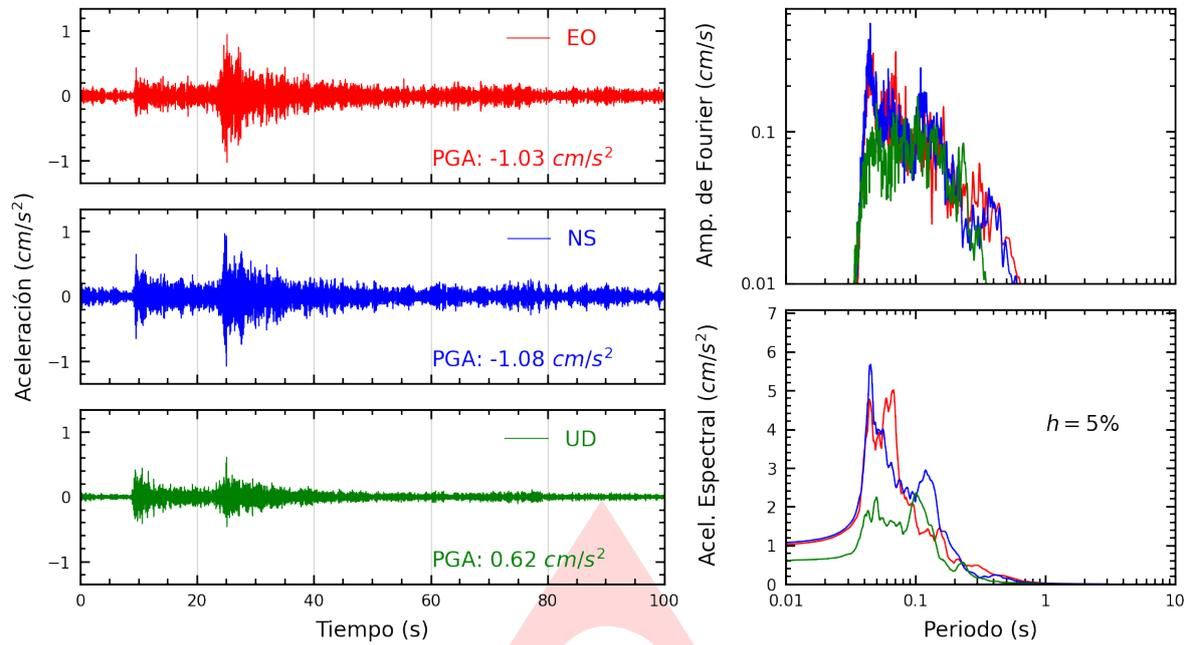
**Figura A.1:** Registros tiempo-historia, espectros de Fourier y de respuesta en las direcciones EO, NS y vertical de la estación SCTRU. Sismo de Chimbote, Santa - Ancash del 2023-09-04, 22:30:15 (Hora local)
