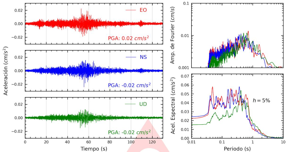
**Figura A.1:** Registros tiempo-historia, espectros de Fourier y de respuesta en las direcciones EO, NS y vertical de la estación UNSA. Sismo de Chala, Caraveli - Arequipa del 2023-09-25, 14:41:36 (Hora local)
