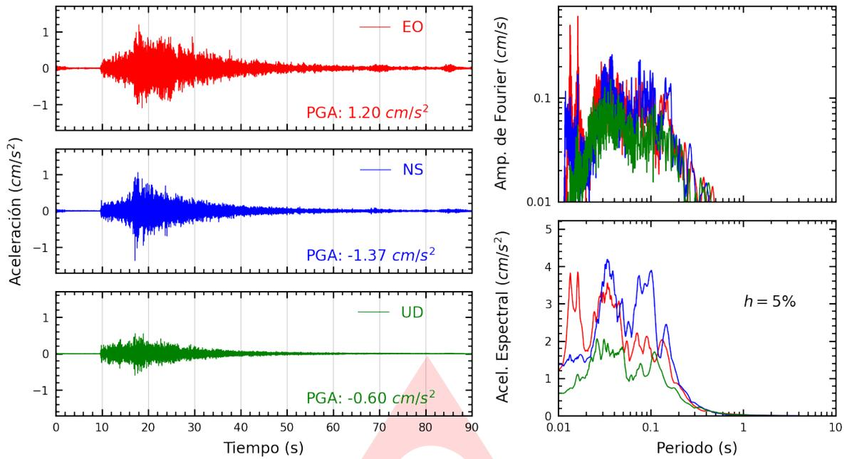
**Figura A.1:** Registros tiempo-historia, espectros de Fourier y de respuesta en las direcciones EO, NS y vertical de la estación UNSA. Sismo de Quilca, Camana - Arequipa del 2023-10-09, 22:50:45 (Hora local)
