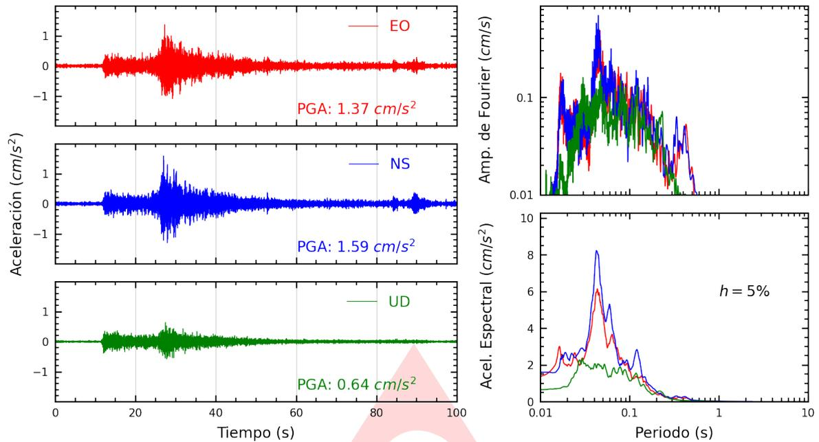
**Figura A.1:** Registros tiempo-historia, espectros de Fourier y de respuesta en las direcciones EO, NS y vertical de la estación SCTR. Sismo de San Pedro De Lloc, Pacasmayo - La Libertad del 2023-10-16, 23:15:54 (Hora local)
