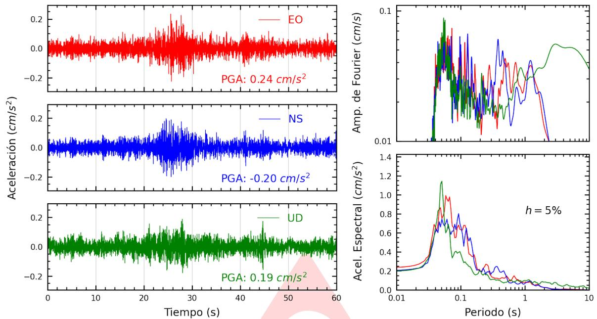
**Figura A.1:** Registros tiempo-historia, espectros de Fourier y de respuesta en las direcciones EO, NS y vertical de la estación SCARQ. Sismo de Pinchollo, Caylloma - Arequipa del 2023-10-31, 17:13:44 (Hora local)
