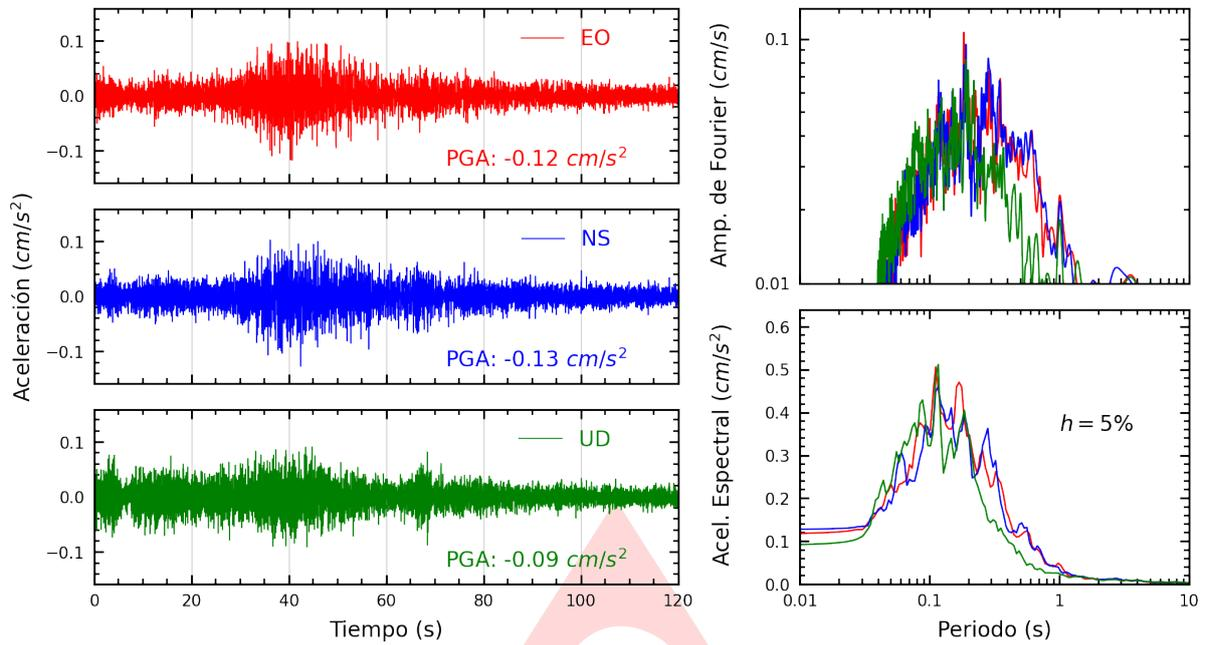
**Figura A.1:** Registros tiempo-historia, espectros de Fourier y de respuesta en las direcciones EO, NS y vertical de la estación UNICA. Sismo de Chala, Caraveli - Arequipa del 2023-11-16, 21:15:22 (Hora local)
