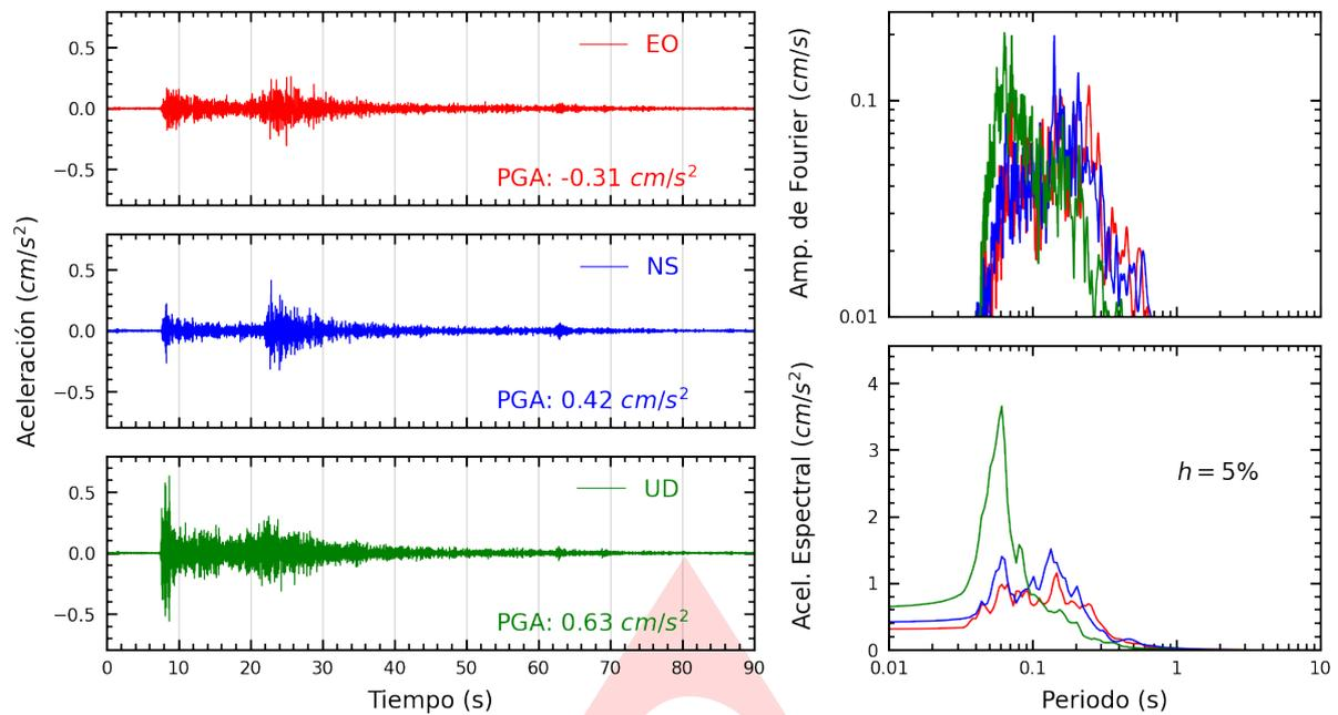
**Figura A.1:** Registros tiempo-historia, espectros de Fourier y de respuesta en las direcciones EO, NS y vertical de la estación UNAAA. Sismo de Nueva Cajamarca, Rioja - San Martín del 2023-11-29, 21:49:17 (Hora local)
