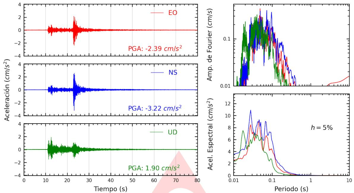
**Figura A.1:** Registros tiempo-historia, espectros de Fourier y de respuesta en las direcciones EO, NS y vertical de la estación SCCHI. Sismo de Chepen, Chepen - La Libertad del 2023-12-13, 17:32:18 (Hora local)
