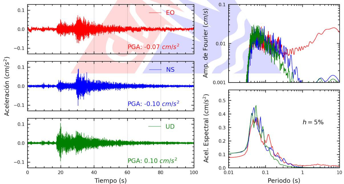
**Figura A.2:** Registros tiempo-historia, espectros de Fourier y de respuesta en las direcciones EO, NS y vertical de la estación SCCHI. Sismo de Olmos, Lambayeque - Lambayeque del 2023-12-18, 09:31:04 (Hora local)
