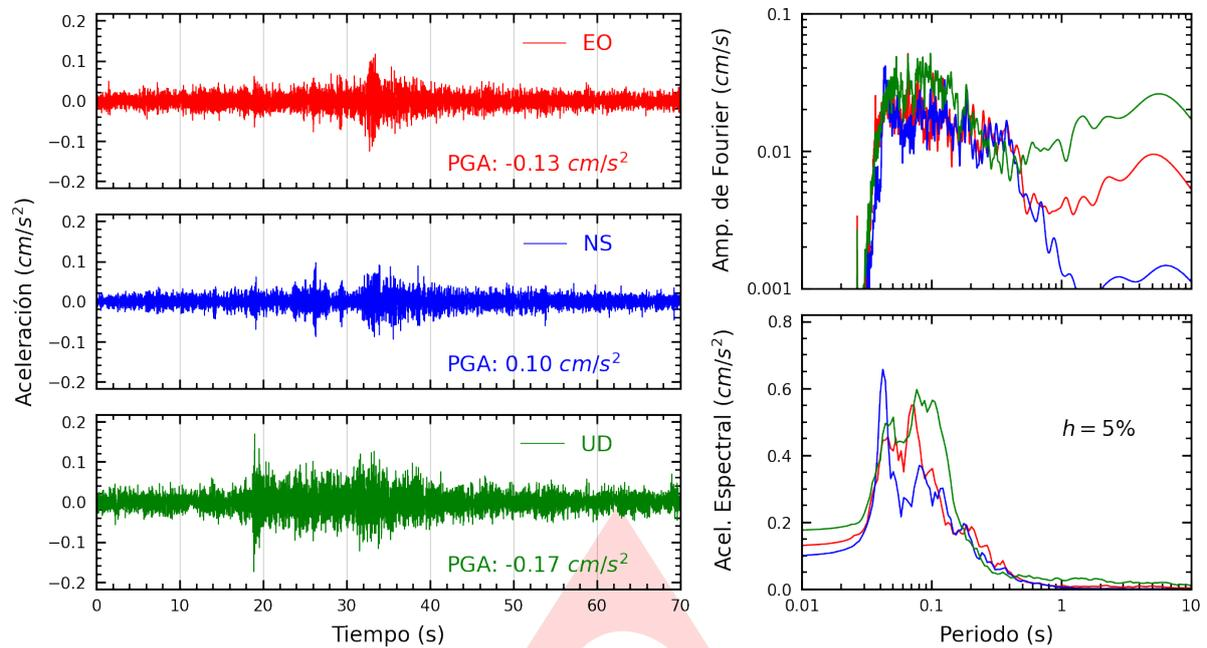
**Figura A.1:** Registros tiempo-historia, espectros de Fourier y de respuesta en las direcciones EO, NS y vertical de la estación SCPIU. Sismo de Olmos, Lambayeque - Lambayeque del 2023-12-18, 09:31:04 (Hora local)
