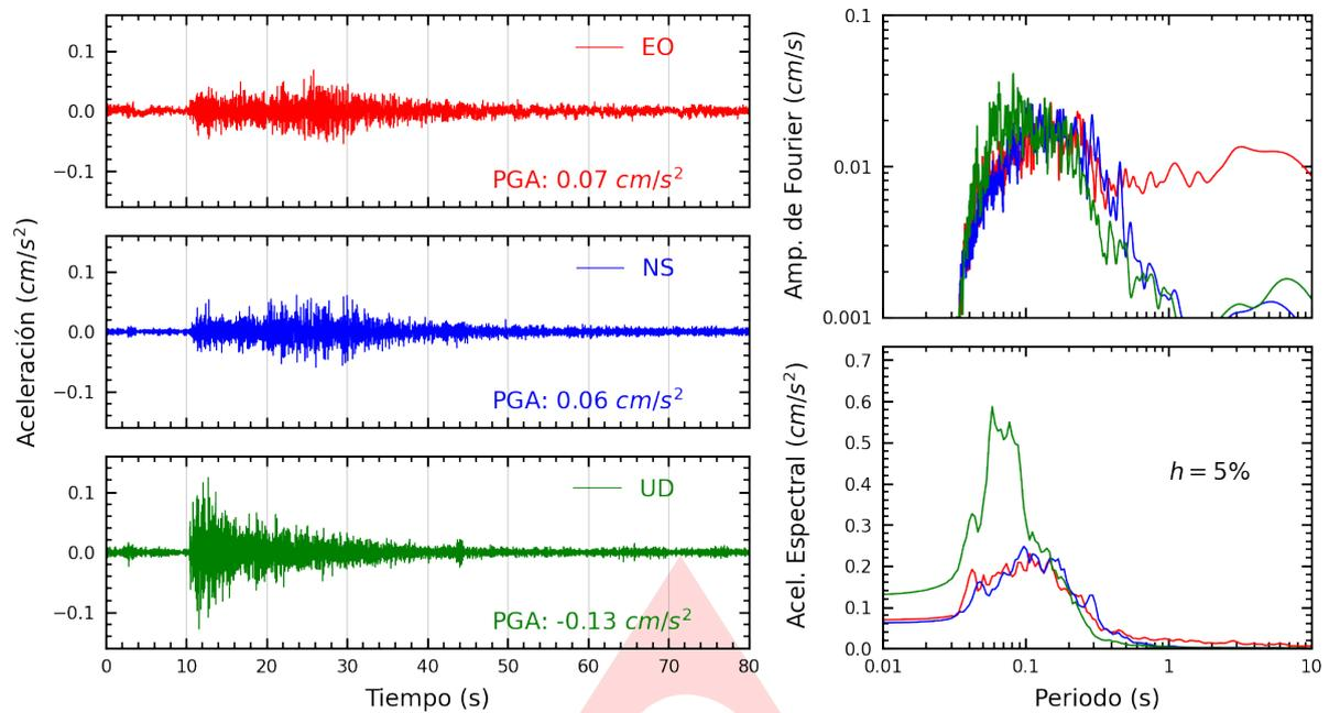
**Figura A.1:** Registros tiempo-historia, espectros de Fourier y de respuesta en las direcciones EO, NS y vertical de la estación SCCHI. Sismo de Sechura, Sechura - Piura del 2023-12-18, 12:05:09 (Hora local)
