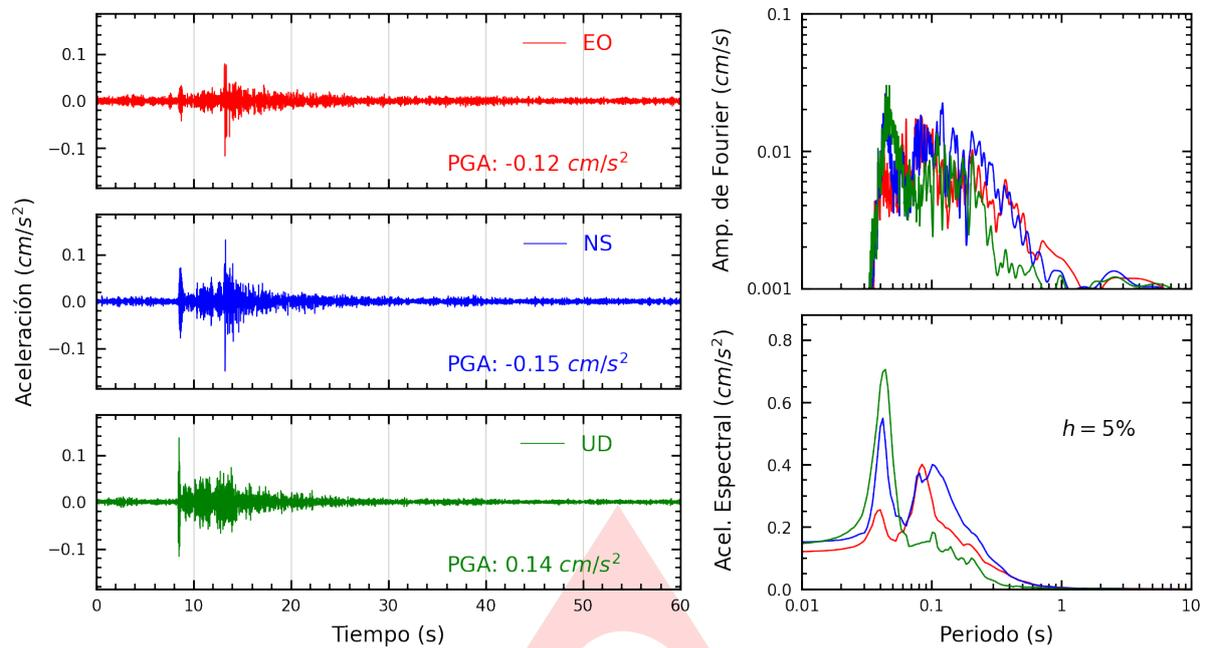
**Figura A.1:** Registros tiempo-historia, espectros de Fourier y de respuesta en las direcciones EO, NS y vertical de la estación UNF. Sismo de Sullana, Sullana - Piura del 2023-12-25, 18:28:41 (Hora local)
