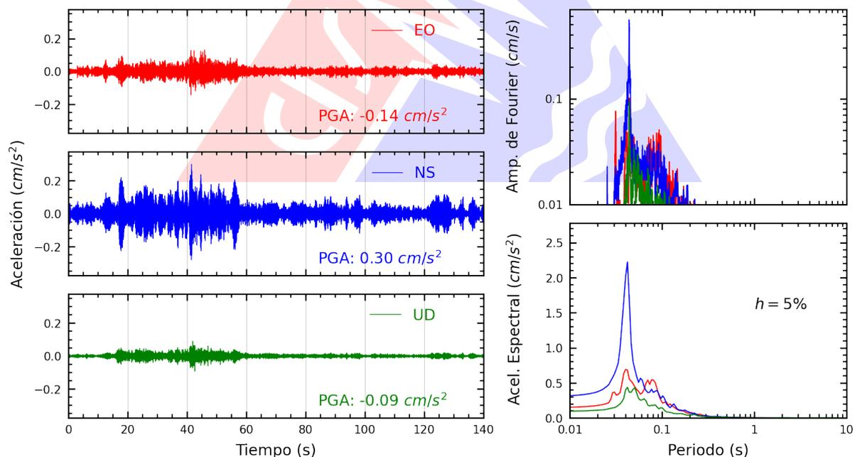
**Figura A.2:** Registros tiempo-historia, espectros de Fourier y de respuesta en las direcciones EO, NS y vertical de la estación UNAM. Sismo de Huambo, Caylloma - Arequipa del 2024-01-10, 17:33:04 (Hora local)
