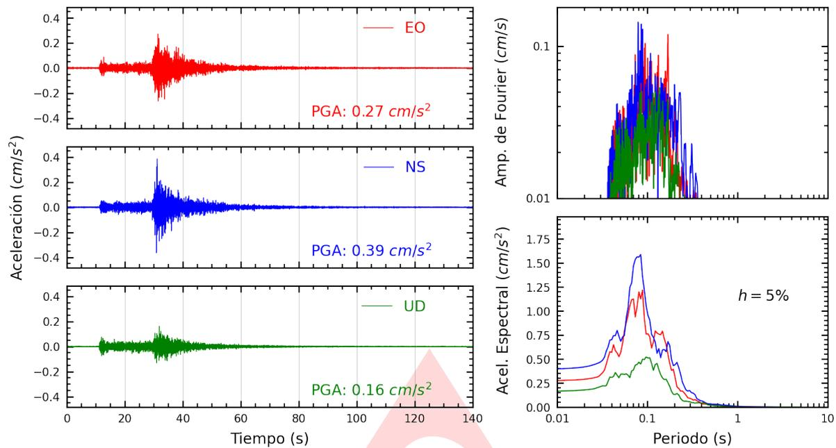
**Figura A.1:** Registros tiempo-historia, espectros de Fourier y de respuesta en las direcciones EO, NS y vertical de la estación UNSA. Sismo de Huambo, Caylloma - Arequipa del 2024-01-10, 17:33:04 (Hora local)
