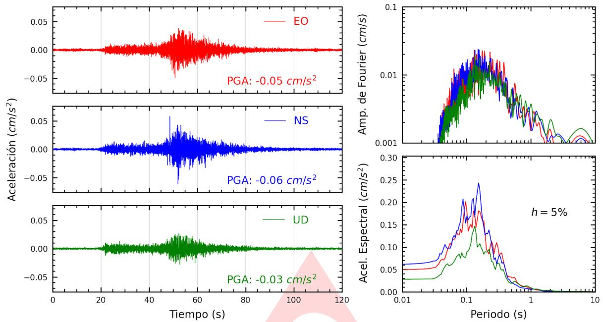
**Figura A.1:** Registros tiempo-historia, espectros de Fourier y de respuesta en las direcciones EO, NS y vertical de la estación UNSA. Sismo de Atico, Caraveli - Arequipa del 2024-01-27, 05:08:23 (Hora local)
