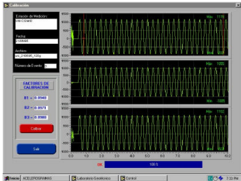
Fig. 6: Señal de Calibración del Instrumento y sus respectivos Factores de Calibración
