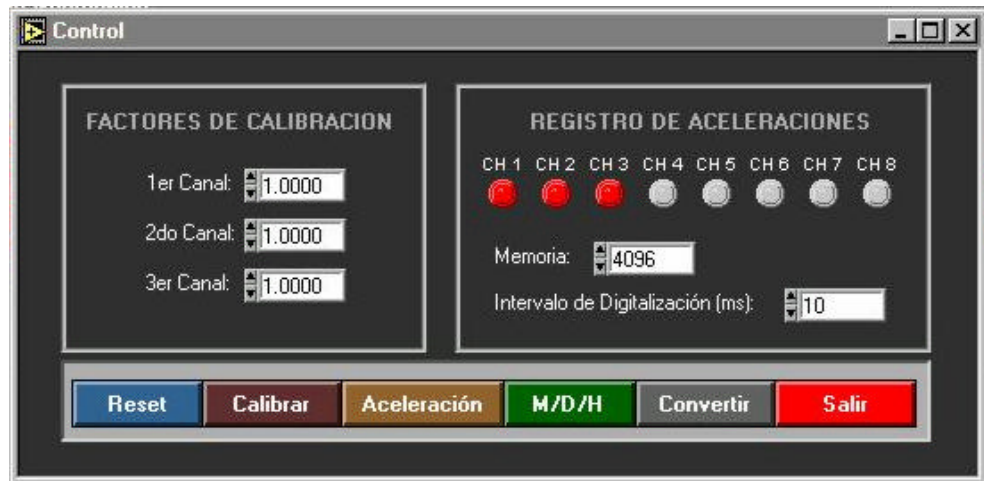
Fig. 5: Panel de Control del Sistema de Adquisición de Datos
