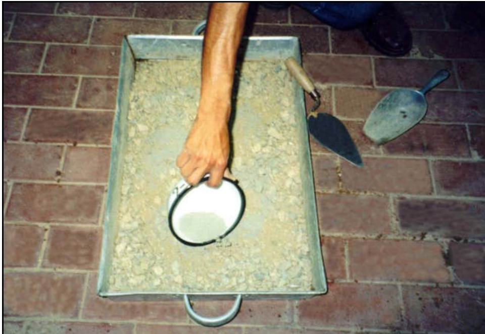
MEZCLA DEL AGREGADO CON EL CEMENTO PARA LA EJECUCIÓN DEL ENSAYO PROCTOR MODIFICADO
