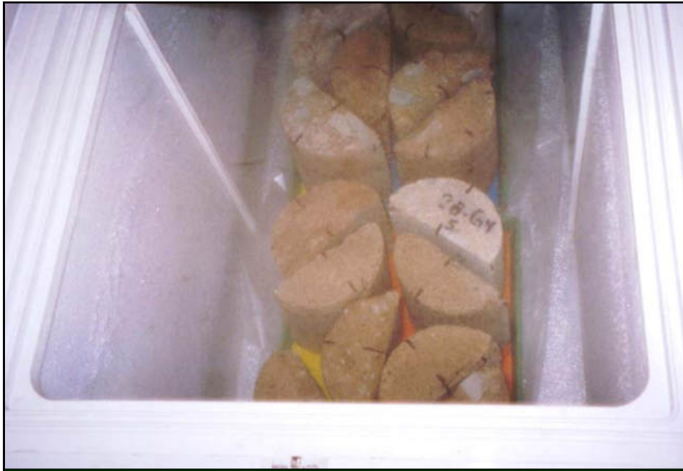
ETAPA DE CONGELAMIENTO. LOS ESPECÍMENES SE COLOCARON EN UNA CONGELADORA A UNA TEMPERATURA CONSTANTE DE -23° C POR UN TIEMPO DE 24 HORAS
