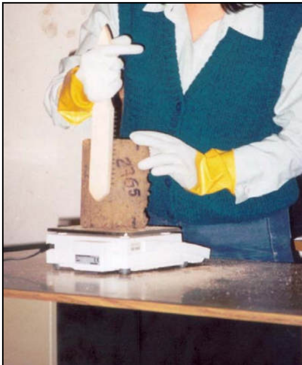
EL ESCOBILLADO SE REALIZÓ EN ALGUNAS OPORTUNIDADES SOBRE UNA BALANZA PARA VERIFICAR LA PRESIÓN APLICADA
