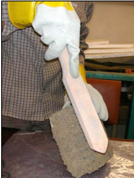
ESCOBILLADO DE ESPECÍMENES, DESPUÉS DE SER RETIRADOS DE LA CÁMARA HÚMEDA
