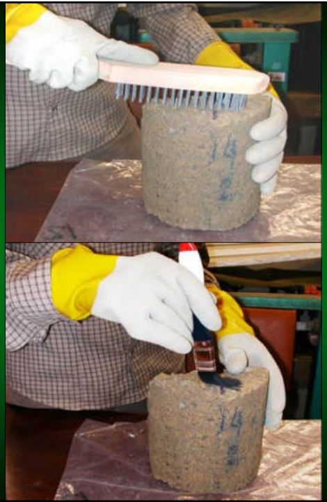
ESCOBILLADO DE ESPECÍMENES, DESPUÉS DE SER RETIRADOS DE LA CÁMARA HÚMEDA
