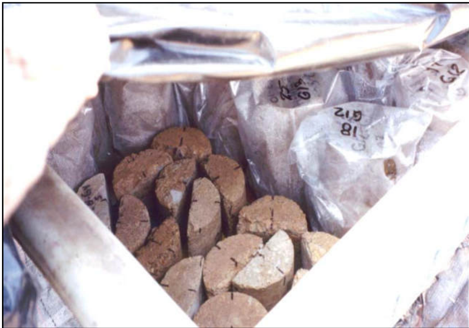
ETAPA DE DESHIELO. LOS ESPECÍMENES SE COLOCARON EN LA CÁMARA HÚMEDA POR 23 HORAS
