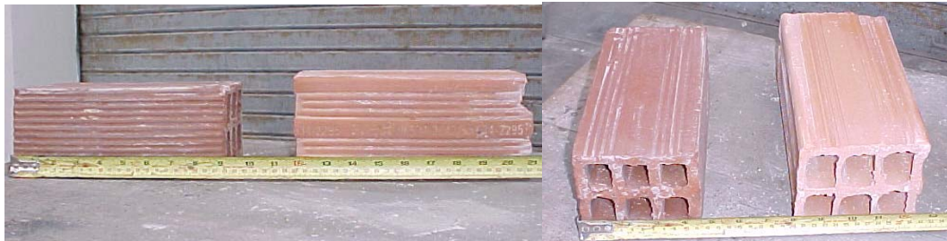
Figura 3. Ladrillos pandereta típicos en vistas lateral y frontal. Artesanal (izquierda) e industrial (derecha).
