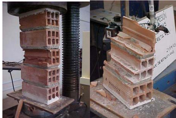
Figura 6. Forma de falla a compresión en pilas de albañilería. Artesanal (izq.) e industrial (der.).
