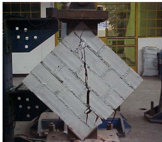
Figura 7. Ensayo de tracción diagonal en muretes.
