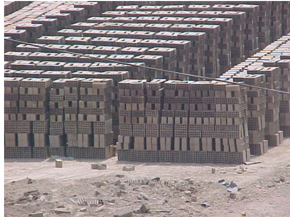
Figura 2. Almacenamiento de ladrillos de fabricación no estandarizada.
