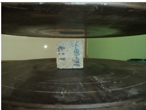
Foto 52. Ensayo de compresión en cubo de mortero CU7-06
