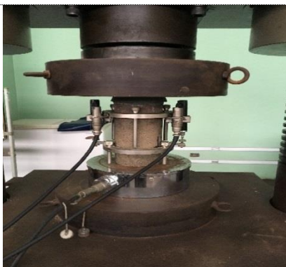
Foto 64. Ensayo de compresión simple en cilindro de mortero CI8-03
