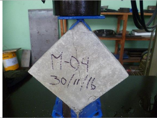
Foto 85. Murete de mortero ensayado M8-04
