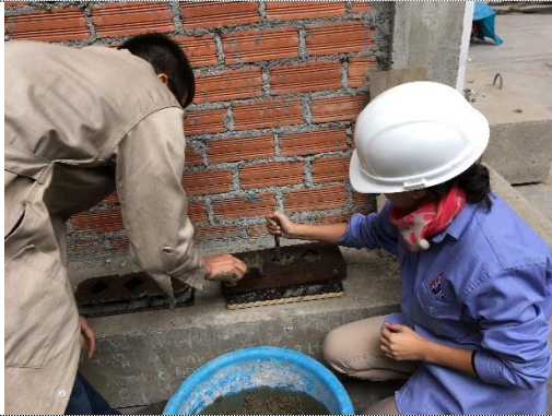
Foto 7. Compactación en dos capas con 25 chuceadas en moldes para cubo
