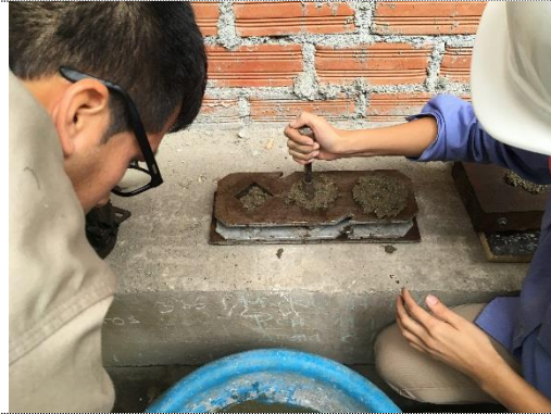
Foto 8. Vaciado y compactación del mortero en dos capas
