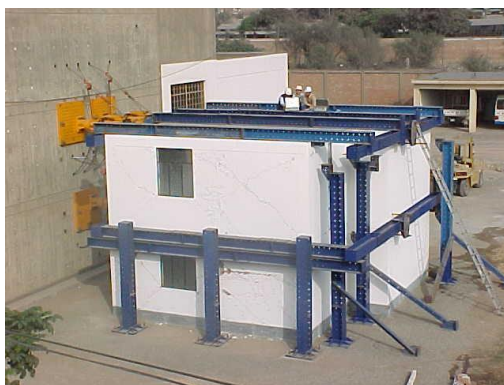
Figura 1. Vivienda de albañilería confinada de dos niveles sometido a ensayo de carga cíclica (CISMID, 2003)
