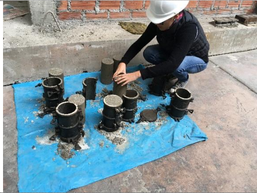
Foto 13. Desencofrado de las probetas cilíndricas
