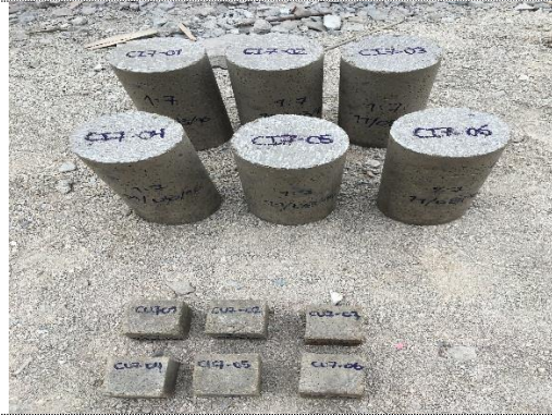
Foto 14. Probetas cilíndricas y cúbicas curadas y listas para los ensayos
