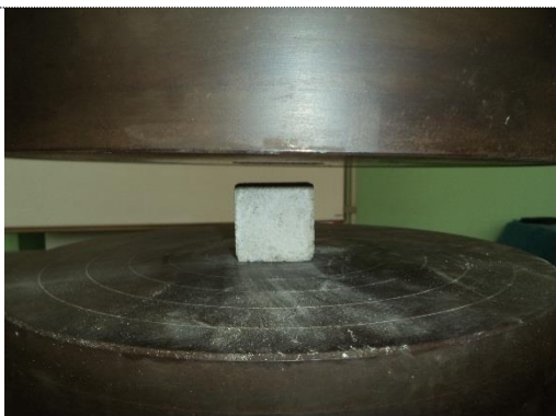
Foto 76. Ensayo de compresión en cubo de mortero CU8-06
