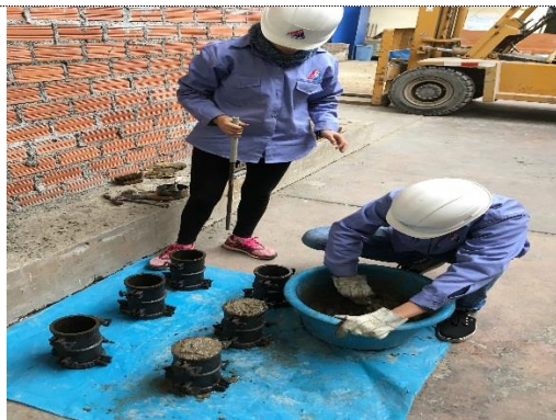
Foto 35. Vaciado de la mezcla de mortero en probetas cilíndricas
