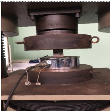
Foto 68. Ensayo de compresión en cubo de mortero CU8-02
