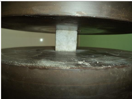
Foto 74. Ensayo de compresión en cubo de mortero CU8-05
