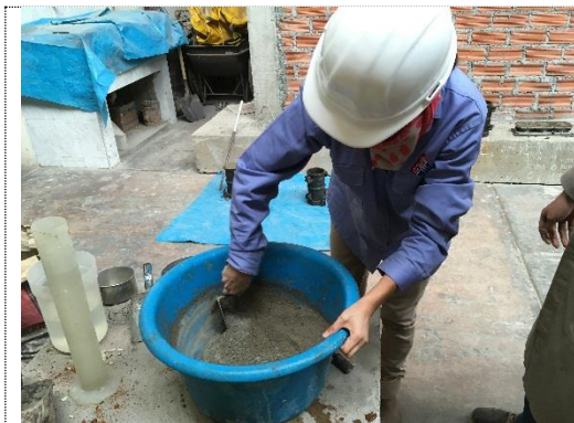
Foto 3 Mezcla de arena y cemento
