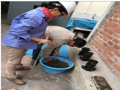
Foto 9. Vaciado del mortero en moldes cilíndricos
