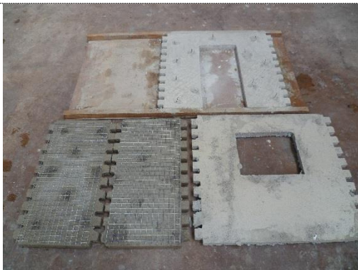
Foto 95. Vista delantera de muros de módulo con reforzamiento total
