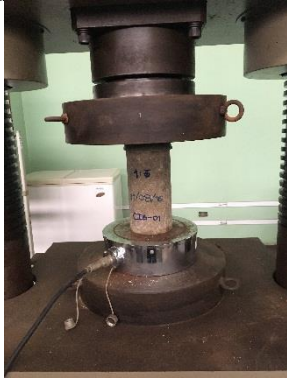
Foto 15. Ensayo de compresión simple en cilindro de mortero CI6-01
