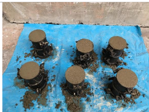
Foto 12. Muestras cilíndricas enrasadas
