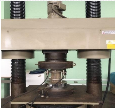
Foto 62. Ensayo de compresión simple en cilindro de mortero CI8-02
