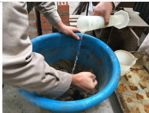
Foto 4. Dosificación de agua
