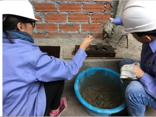
Foto 34. Compactación de la mezcla en probetas cúbicas
