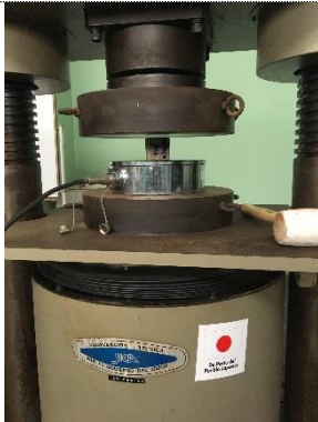
Foto 29. Ensayo de compresión en cubo de mortero CU6-02
