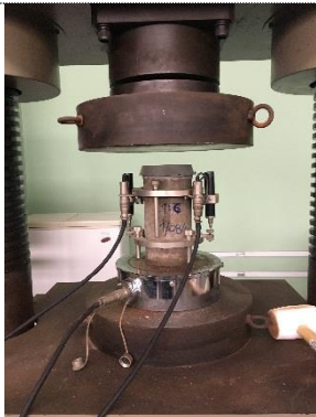
Foto 17. Ensayo de compresión con deformímetros en cilindro de mortero CI6-02
