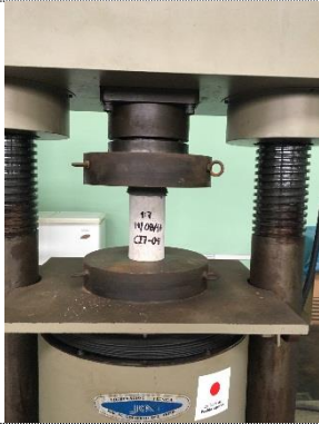
Foto 21. Ensayo de compresión simple en cilindro de mortero CI6-04
