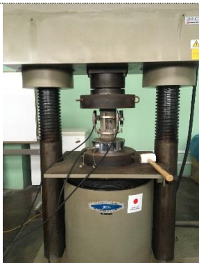
Foto 19. Ensayo de compresión con deformímetros en cilindro de mortero CI6-03
