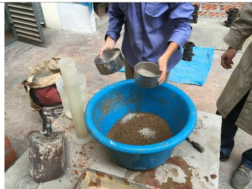
Foto 2. Dosificación de cemento
