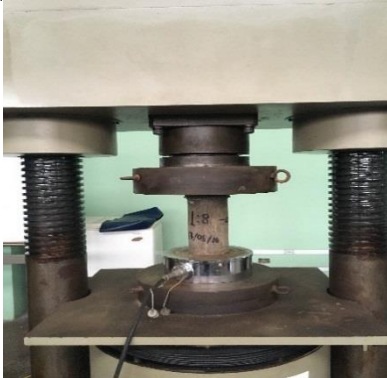
Foto 60. Ensayo de compresión simple en cilindro de mortero CI8-01
