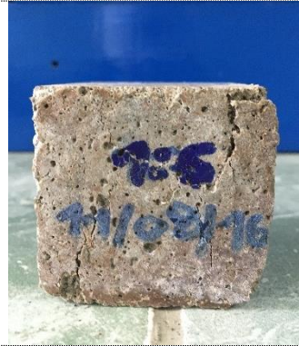
Foto 28. Cubo de mortero ensayado CU6-01
