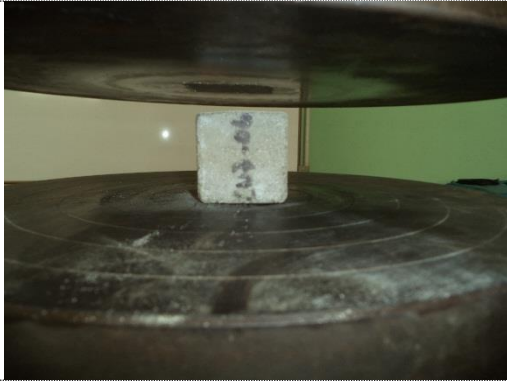
Foto 72. Ensayo de compresión en cubo de mortero CU8-04
