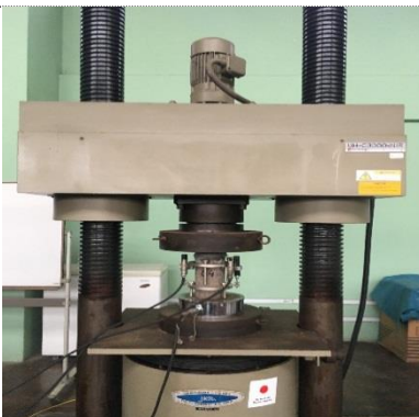
Foto 39. Ensayo de compresión con deformímetros en cilindro de mortero CI7-04
