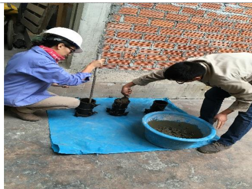
Foto 10. Compactación en tres capas con 21 chuceadas en molde cilíndrico
