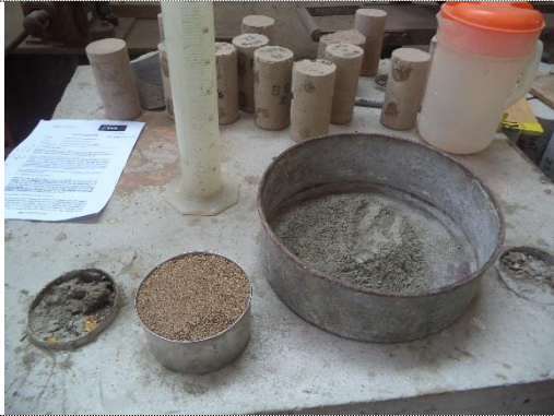
Foto 54. Materiales de mezcla 1:8 para muretes
