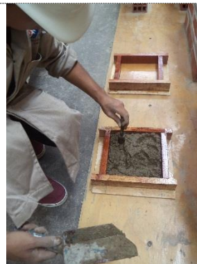
Foto 57. Compactación de la muestra, 25 golpes por capa
