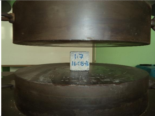
Foto 48. Ensayo de compresión en cubo de mortero CU7-02
