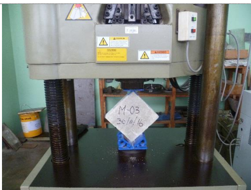
Foto 82. Ensayo de compresión en murete de mortero M8-03
