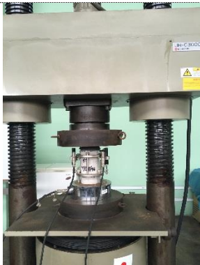
Foto 23. Ensayo de compresión con deformímetros en cilindro de mortero CI6-05
