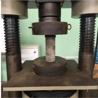
Foto 37. Ensayo de compresión simple en cilindro de mortero CI7-03
