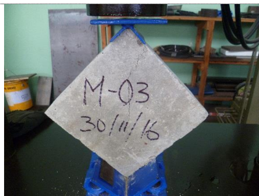
Foto 83. Murete de mortero ensayado M8-03
