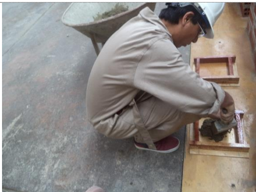
Foto 56. Vaciado del mortero en tres capas.
