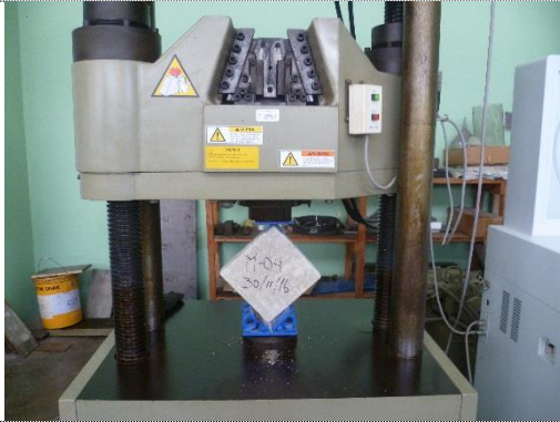
Foto 84. Ensayo de compresión en murete de mortero M8-04
