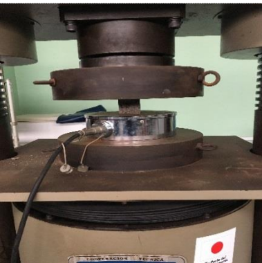
Foto 70. Ensayo de compresión en cubo de mortero CU8-03
