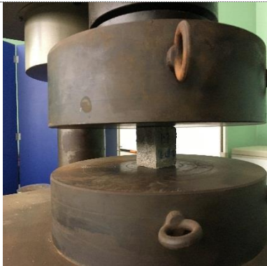
Foto 44. Ensayo de compresión en cubo de mortero CU7-04
