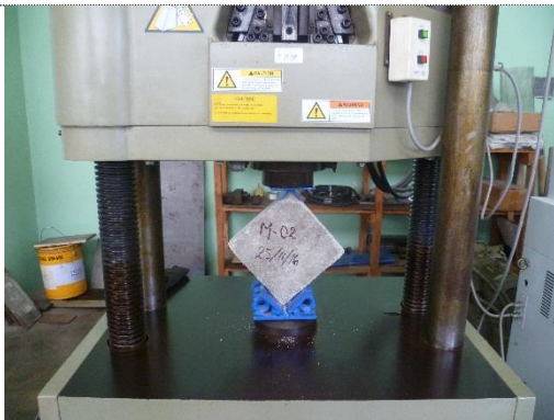
Foto 80. Ensayo de compresión en murete de mortero M8-02
