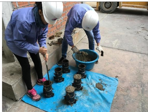
Foto 36. Compactado cada 25 golpes en probetas cilíndricas
