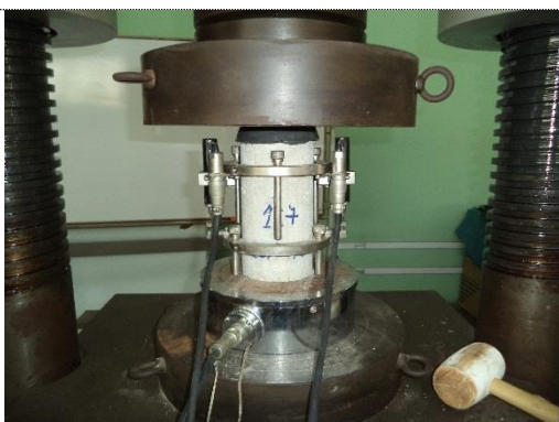
Foto 25. Ensayo de compresión con deformímetros en cilindro de mortero CI6-06
