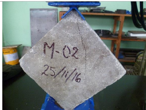
Foto 81. Murete de mortero ensayado M8-02
