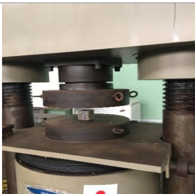
Foto 46. Ensayo de compresión en cubo de mortero CU7-05
