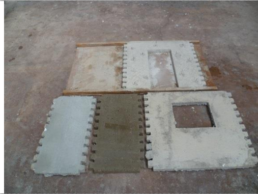
Foto 94. Muros de módulo con reforzamiento parcial
