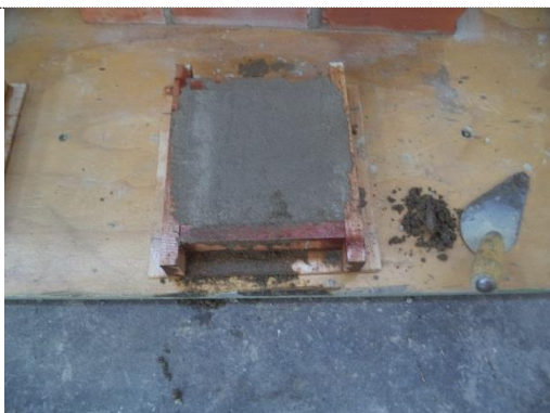
Foto 58. Nivelación y enrasado de la muestra
