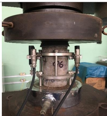
Foto 41. Ensayo de compresión con deformímetros en cilindro de mortero CI7-05
