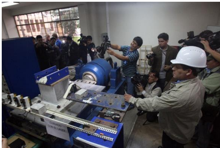
Figura 18. Ensayos de módulo reducido en mesa vibradora de CISMID
