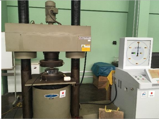
Foto 27. Ensayo de compresión en cubo de mortero CU6-01
