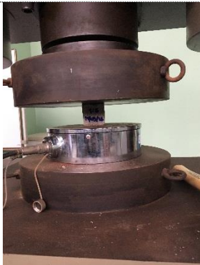
Foto 31. Ensayo de compresión en cubo de mortero CU6-03
