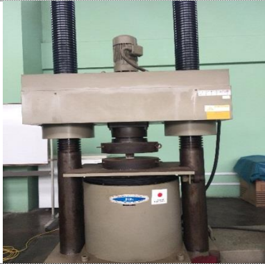
Foto 42. Ensayo de compresión en cubo de mortero CU7-01
