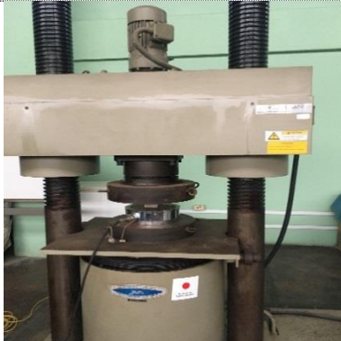
Foto 66. Ensayo de compresión en cubo de mortero CU8-01
