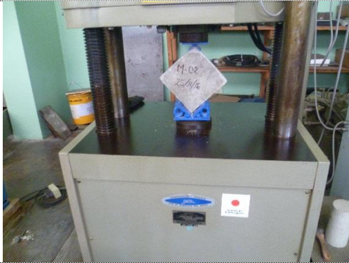
Foto 78. Ensayo de compresión en murete de mortero M8-01
