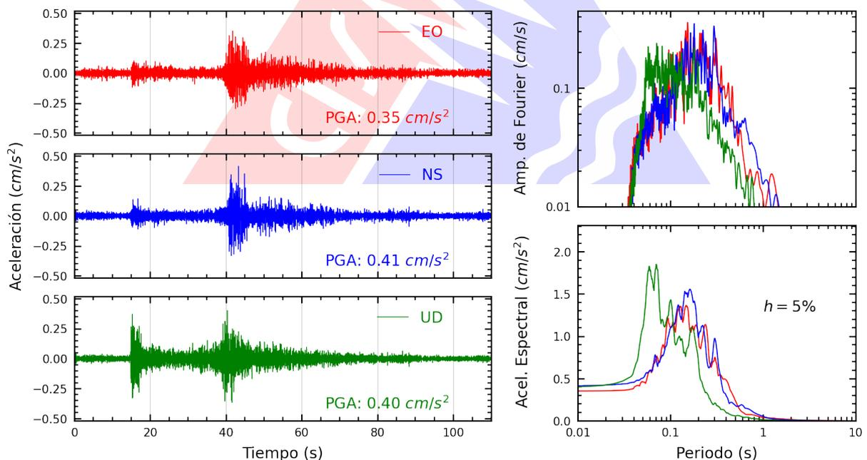
**Figura A.2:** Registros tiempo-historia, espectros de Fourier y de respuesta en las direcciones EO, NS y vertical de la estación UNAAA. Sismo de Pastaza, Alto Amazonas - Loreto del 2022-10-28, 18:19:58 (Hora local)
