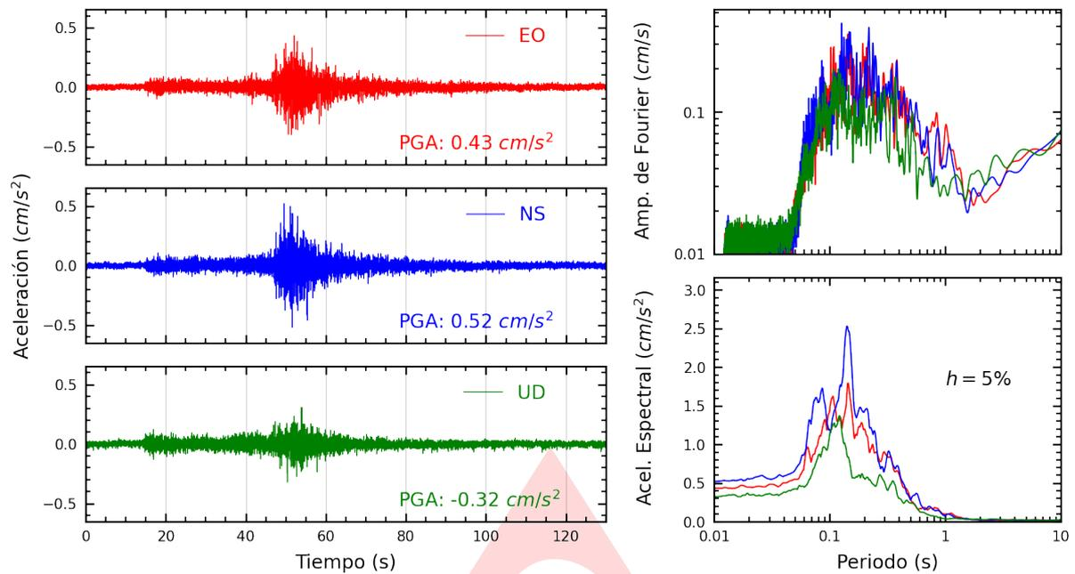
**Figura A.1:** Registros tiempo-historia, espectros de Fourier y de respuesta en las direcciones EO, NS y vertical de la estación UNTRM. Sismo de Pastaza, Alto Amazonas - Loreto del 2022-10-28, 18:19:58 (Hora local)
