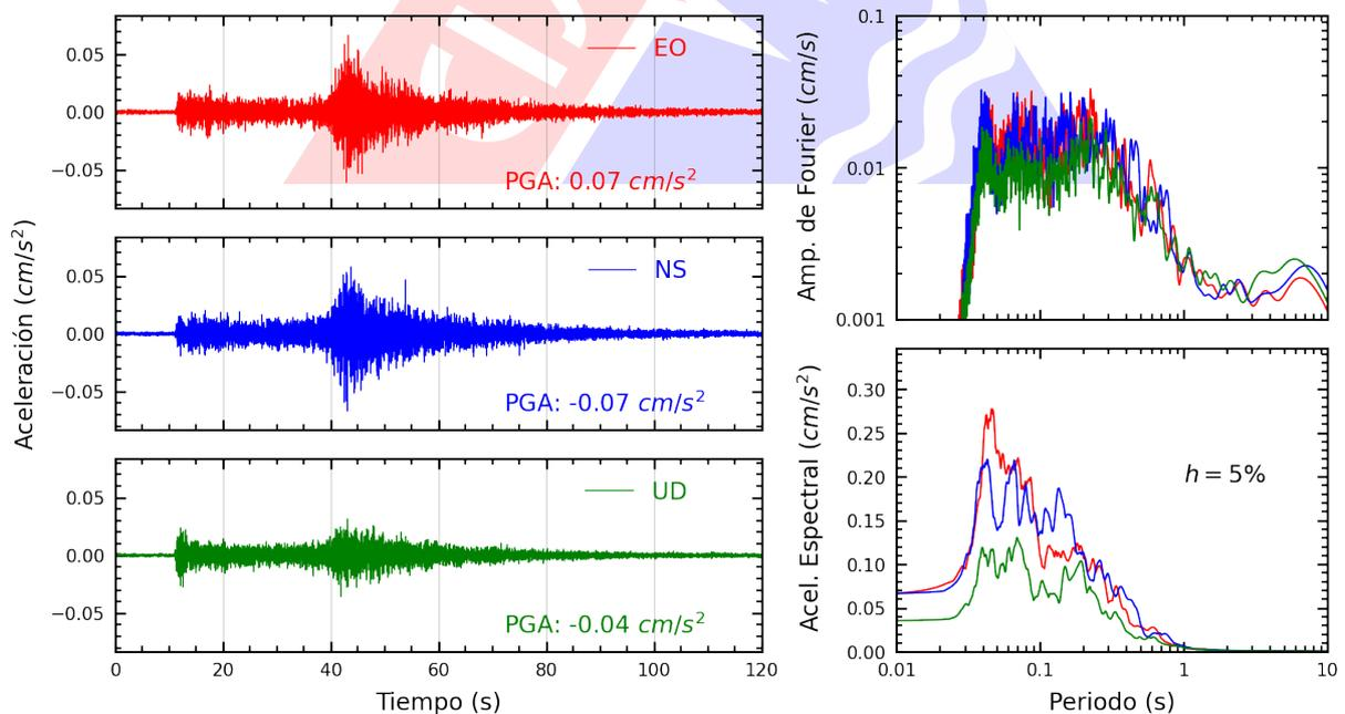
**Figura A.4:** Registros tiempo-historia, espectros de Fourier y de respuesta en las direcciones EO, NS y vertical de la estación UNSA. Sismo de Calana, Tacna - Tacna del 2022-11-09, 16:33:41 (Hora local)
