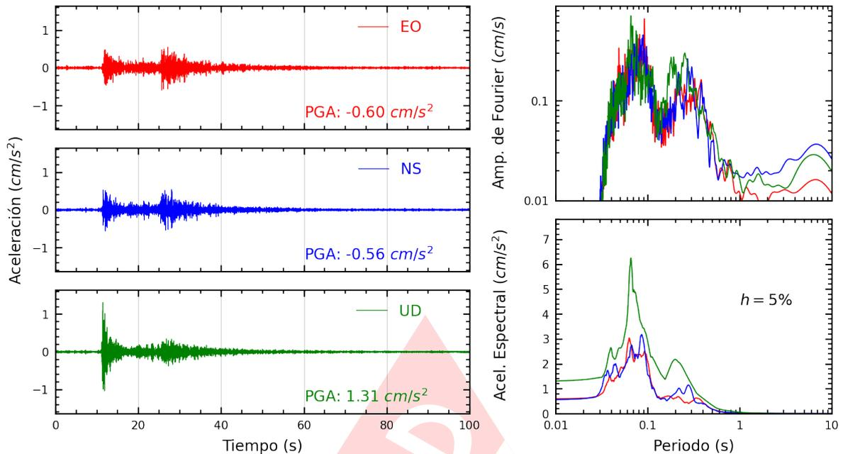
**Figura A.3:** Registros tiempo-historia, espectros de Fourier y de respuesta en las direcciones EO, NS y vertical de la estación CREY. Sismo de Calana, Tacna - Tacna del 2022-11-09, 16:33:41 (Hora local)
