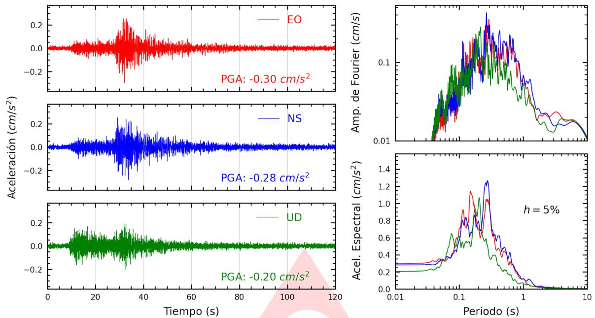
**Figura A.1:** Registros tiempo-historia, espectros de Fourier y de respuesta en las direcciones EO, NS y vertical de la estación UNICA. Sismo de Marcona, Nazca - Ica del 2022-12-18, 03:24:22 (Hora local)
