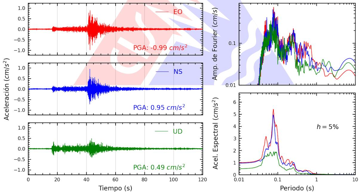
**Figura A.2:** Registros tiempo-historia, espectros de Fourier y de respuesta en las direcciones EO, NS y vertical de la estación CREY. Sismo de Conduriri, El Collao - Puno del 2022-12-31, 18:04:09 (Hora local)
