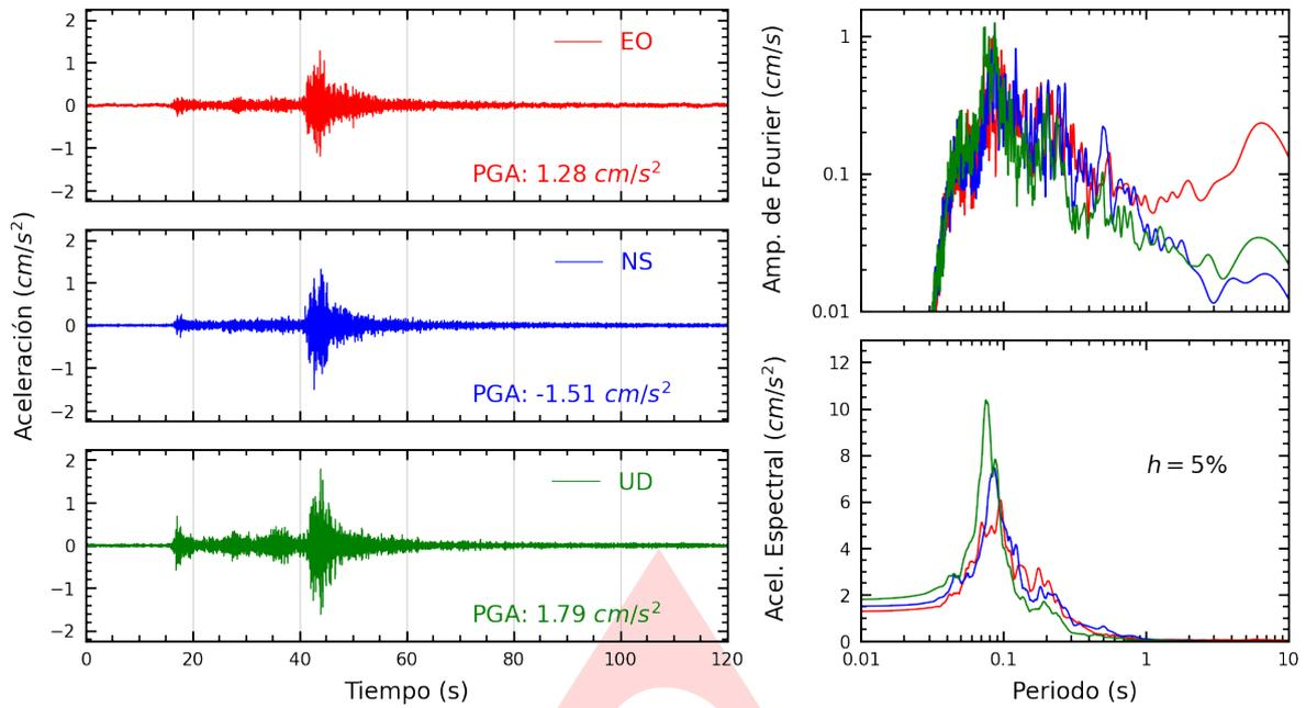
**Figura A.1:** Registros tiempo-historia, espectros de Fourier y de respuesta en las direcciones EO, NS y vertical de la estación UJBG3. Sismo de Conduriri, El Collao - Puno del 2022-12-31, 18:04:09 (Hora local)
